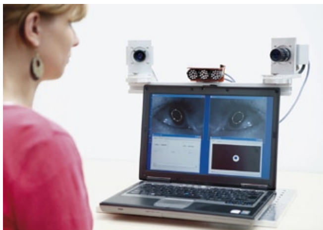
Stereoskopisches Eye Tracking System mit Display der Pupillenpositionen aus linker und rechter Kameraperspektive
