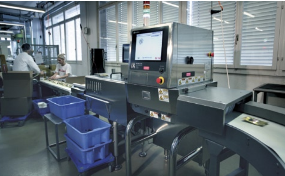
Das Röntgenprüfsystem IX-EA-2161 ist die letzte Station vor der Endverpackung.
