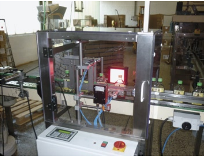
Abb. 2a und 2b: Im Durchlicht-Verfahren wird der Füllstand als dunkle Linie sichtbar – hervorgerufen durch die Lichtbrechung an der Flüssigkeitsoberfläche.
