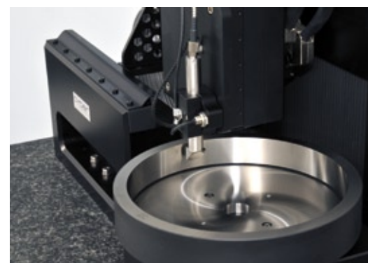
Die Oberfläche eines runden Bauteils wird auf Defekte hin untersucht
