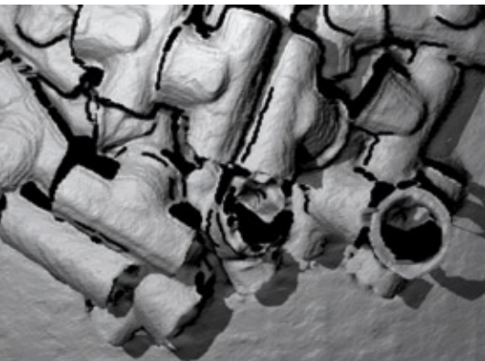
Mit einem Laserscanner aufgenommene 3D-Punktwolke. Die Szene zeigt Stördaten, fehlende Daten und Verdeckungen.
