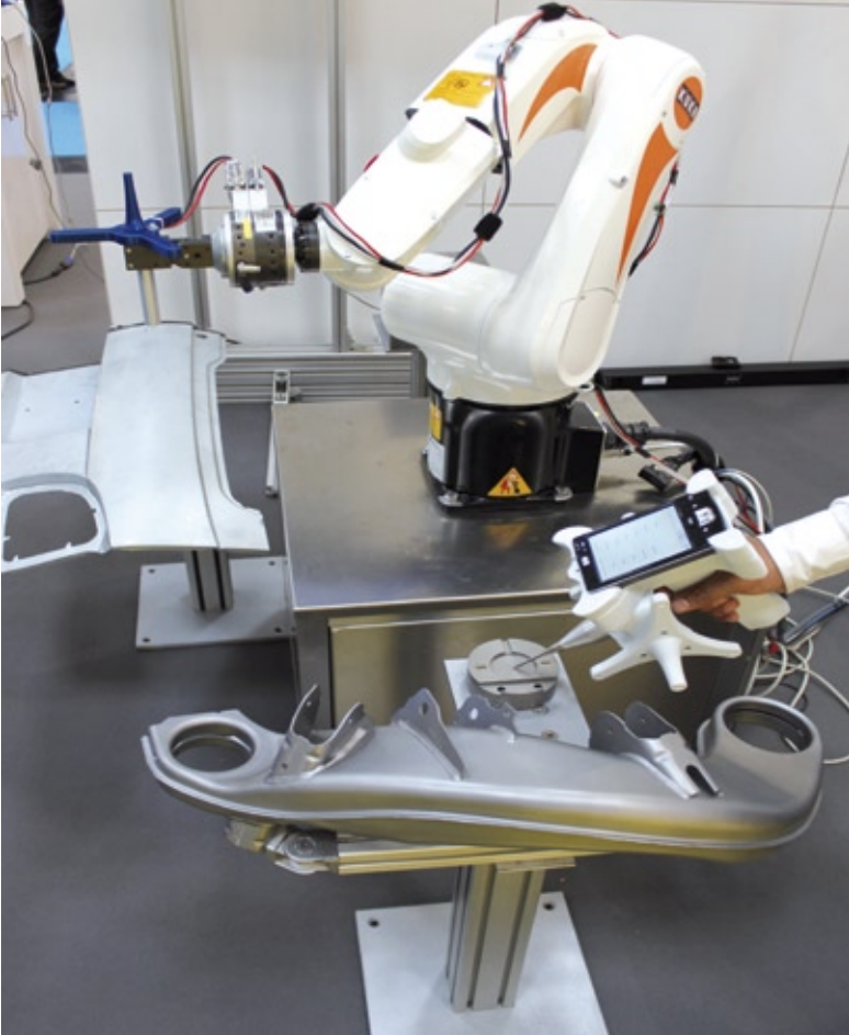
Die Bahnkurve des Roboters kann über den 6D-Programmiergriff mit integriertem PDA schnell eingelesen werden.
