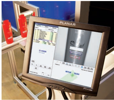
Die Inspektionlösung von CI-Vision prüft bei L'Oreal Verpackungen
