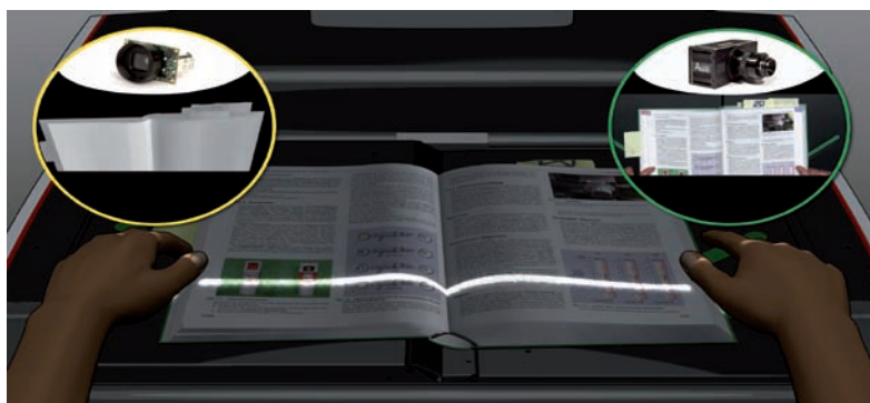
Die Projektion einer Scanzeile (grün) wird über das Buch bewegt, während die Matrixkamera (gelb) direkt auf die Buchwippe zeigt
