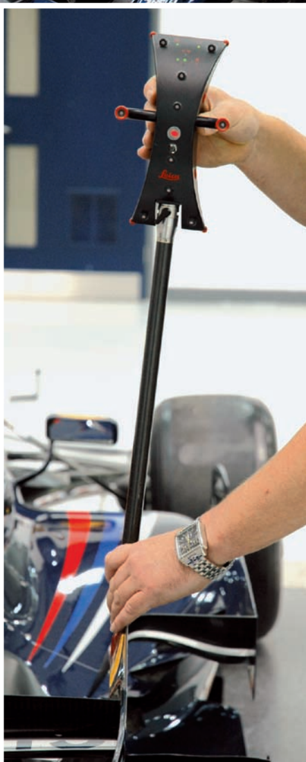
Extreme Tasterlängen sind kein Problem für die Leica T-Probe
