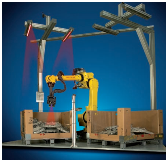
Fanuc M710iC 50 stereobasiertes Bin Picking- System hat die Bildverarbeitung im Controller des Roboters integriert
