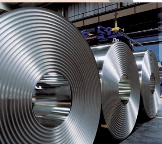
Coils sind der Rohstoff für viele weitere Produkte, wichtiges Qualitätskriterium ist dabei die möglichst konstante Dicke
