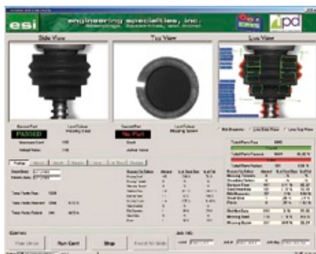
Visualisierung der ESI „Green Seal Machine“ – hier werden nur die Steuerungselemente und Daten angezeigt, die der Anlagenbediener benötigt
