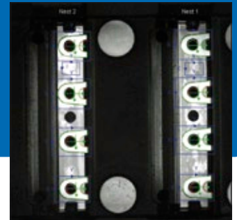
Die Vollzähligkeit und präzise Lage der Spacer (Abstandshalter) wird im schnellen Produktionstakt gewährleistet
