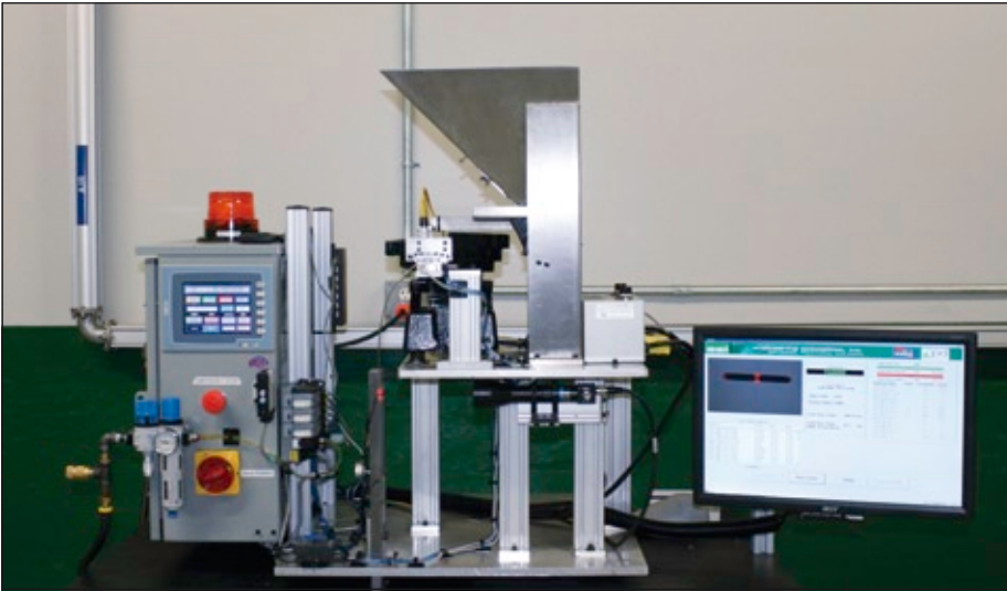
Mit zwei Kameras an der automatisierten Montageanlage wird jede Dichtung beim Aufsatz auf eine Schraube automatisch auf Austrieb geprüft
