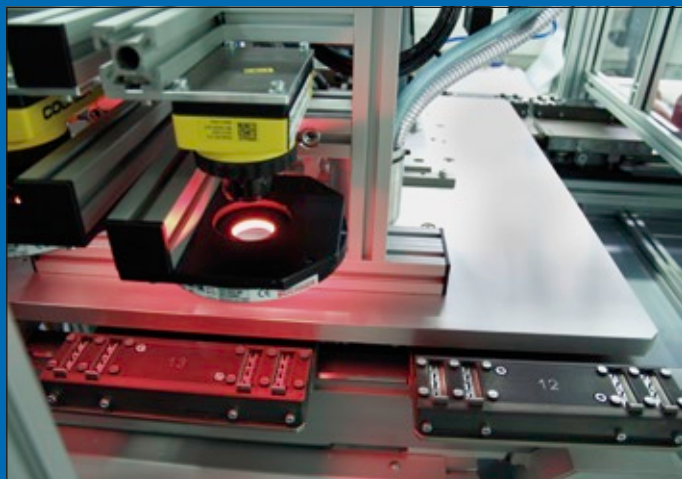
Geprüfter Kopfstand – zwei In-Sight 5100 prüfen das Vorhandensein und die korrekte Position von Spacer, Oberschneide und Kunststoff-Topcap
