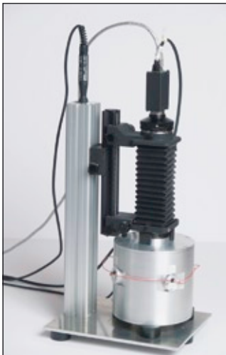
Abb. 3: Ulbrichtkugel mit LED-Beleuchtung zur Kameravermessung nach dem EMVA 1288 Standard
