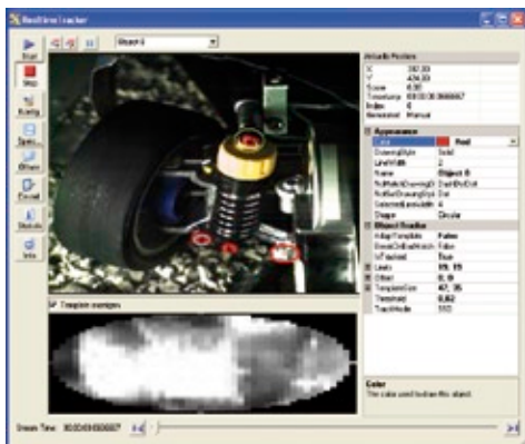
RealtimeTracker: 2D-Echtzeit-Auf- zeichnung des Stoß- dämpfer-Verhaltens
