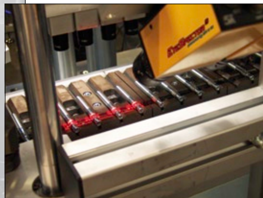
EyeSpector bei der Montagekontrolle von Betonankern
