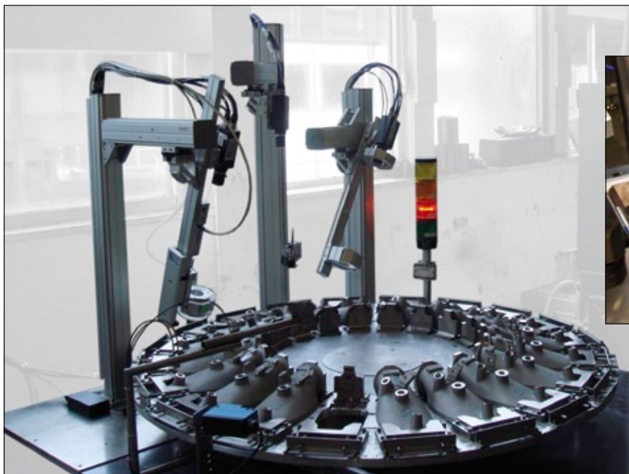
Intelligente Kameras im Einsatz in einer Prüfanlage für Automobilkomponenten
