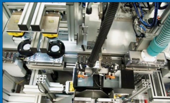
Spiegelkabinett – mittels einer komplexen Anordnung lichtdurchlässiger Spiegel kümmern sich vier In-Sight 5403 um die Qualitätsendkontrolle mit extremer Präzision
