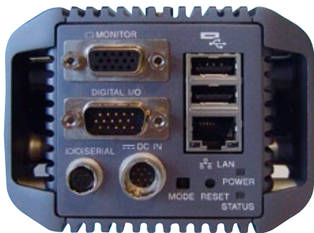
Die Sony Smart Camera verfügt über eine enorme Schnittstellenvielfalt mit RS-232, 4x ISO In/ 8x ISO Out, 2x USB 2.0, Ethernet 10/100/1000 Mbps sowie Monitor Ausgang
