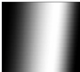
Bei nicht symmetrischer Gaussverteilung des Laserlinienprofils ist das Resultat des COG mit einem systematischen Fehler behaftet
