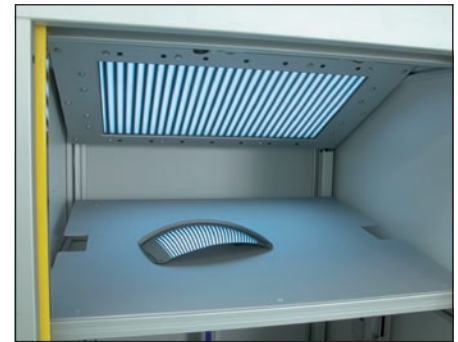
Ein Blick in das System RC-compact: Die verzerrte Reflexion des LKW-Spiegels ist deutlich erkennbar
