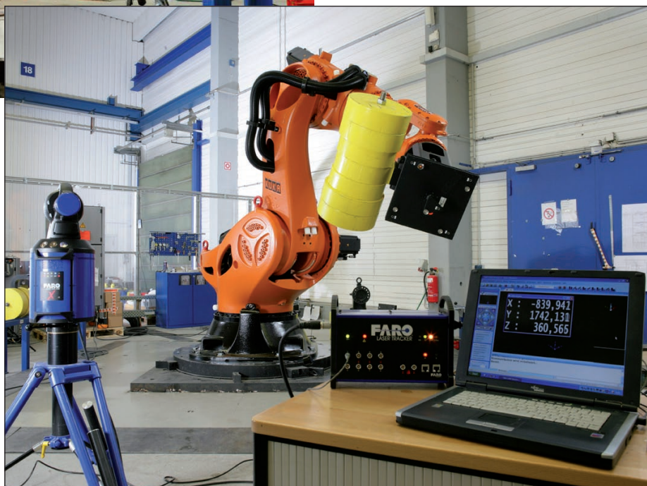
In der Halle 6 des Augsburgischen Kuka Werkes werden die Positionsmessungen und Validierungen für sämtliche Roboter durchgeführt
