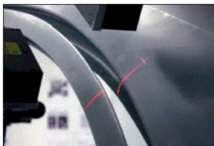
Abb. 3: Stereosystem, Prinzipaufbau (links) und Stereosystem, Lichtschnittsensoren am Türspalt (rechts)
