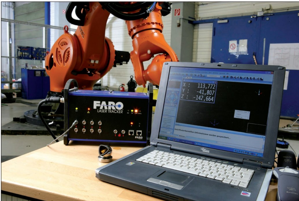
Durch den Einsatz der Faro Laser Tracker konnte die Genauigkeit der Roboter im gesamten Arbeitsbereich von etwa einem Millimeter auf unter 0,7 mm reduziert werden
