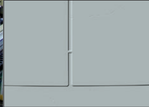
Solarzellenbild mit Riss nach Vorverarbeitung der Bilddaten
