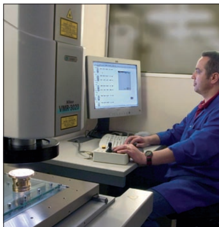
Qualitätskontrolle bei Westwind mit einer Nikon Koordinaten-Messmaschine – Typ Nexiv VMR3020
