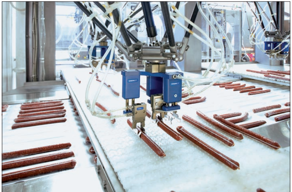
Mithilfe von Vision-Systemen können unsortierte Minisalamis in Windeseile erkannt und anschließend von Robotern ge Griffen werden
