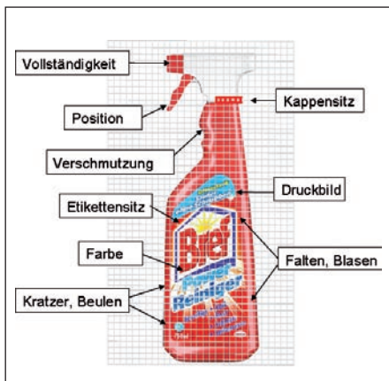
Für die Multiattributkontrolle mit statistischen Kenngrößen zerlegt der Computer das digitale Kamerabild in tausende Kästchen. Für jedes Kästchen sind erlaubte Abweichungen definiert.
