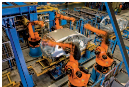
Das Rezept für mehr Qualität: Vollautomatisierte Messzelle zur Kontrolle selbst schwer zugänglicher Messpunkte
