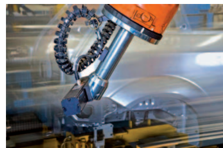
Temperaturkompensierte GGS Sensoren, mobil am Roboterarm montiert, helfen höchste Qualität zu sichern.
