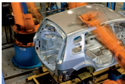
In-line Messtechnik im Kölner Fordwerk
