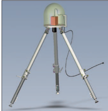
Mobiles Sfs-Messsystem mit 200 × 200 mm 2 Messfeld. Die wesentlichen Elemente sind die Kamera im Kopf und die LED-Gruppen an den unteren Enden der Stativbeine
