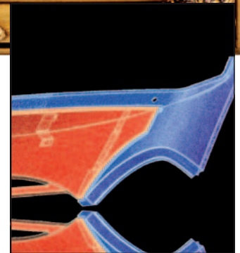
Beispiel einer typischen technischen HighEnd-Applikation: Reverse Engineering an einer Frontschürze eines Wohnmobiles
