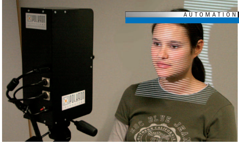
Der Scanner projiziert eine Folge von Streifenmustern auf das Gesicht, diese Muster werden von einer Kamera erfasst, eine zweite, hochauflösende Farbkamera nimmt zur gleichen Zeit ein Foto des Gesichts auf
