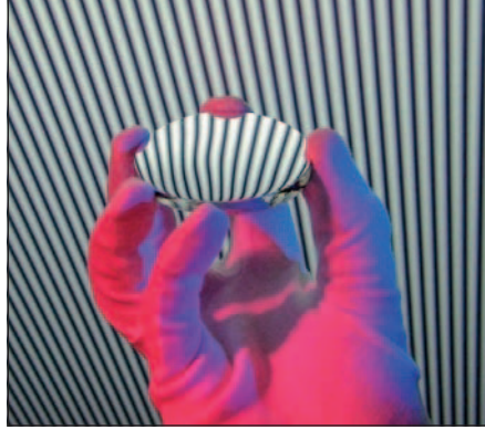
Spiegelung von Streifenmustern in einer Linse
