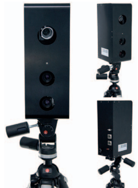
Der Kopfscanner viSense arbeitet nach der „Structured Light“ Methode
