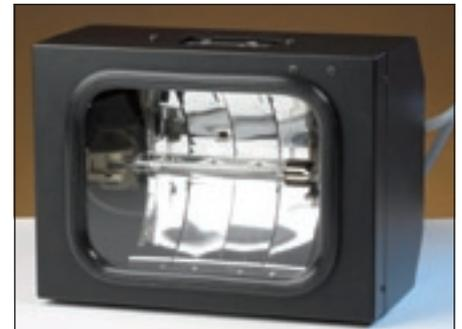
Lichtquelle (Modell Ih-q400i, Fa. LEJ GmbH, Jena) basierend auf einer Metalldampf Lampe für die Bandkontrolle
