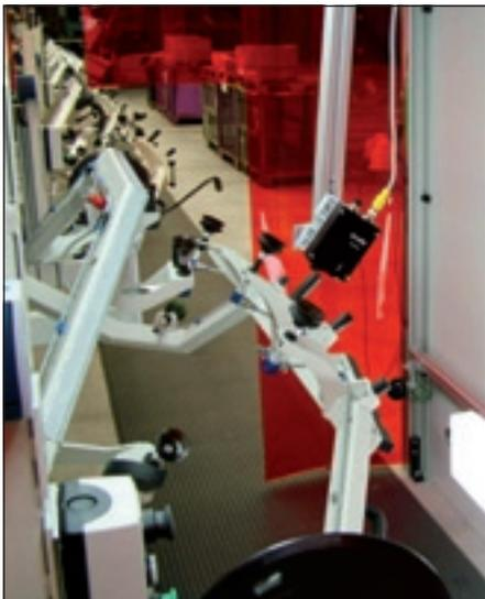
VeriColor ermöglicht eine einfache Farbverifizierung im Produktionsprozess und muss zur Messung nicht abgeschirmt werden, da das Umgebungslicht die Messung nicht beeinflusst
