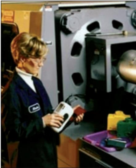
Mit einem Spektralphotometer kann auf einfachste Weise ein Pass/Fail-Prüfung durchgeführt werden, unglücklicherweise bedürfen diese Messgeräte eines direkten Oberflächenkontaktes
