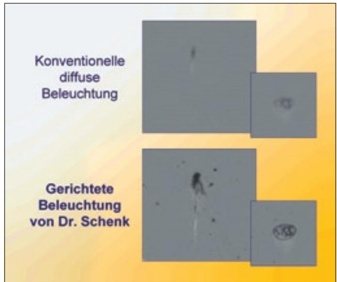
Vergleich einer konventionellen, diffusen Beleuchtung mit der gerichteten Beleuchtung von Dr. Schenk
