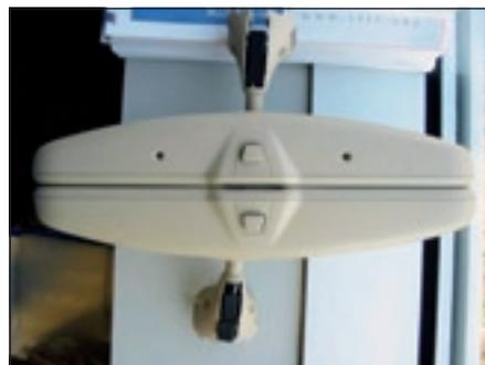
Metamerie : Im Gegensatz zur Betrachtung bei Glühlampenlicht erkennt das menschliche Auge den Montagefehler in den Farbvarianten des Spiegels bei Tageslicht
