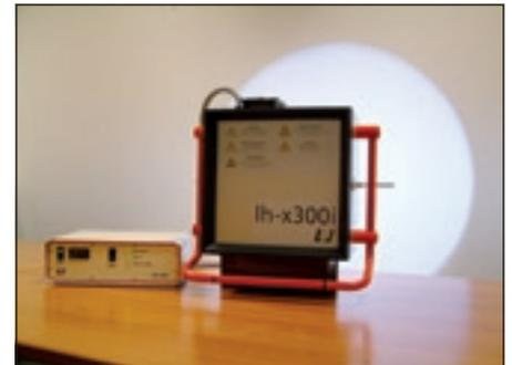
Beleuchtungssystem (Ih-x300i, Fa. LEJ GmbH, Jena) für die Oberflächeninspektion in der Glasfertigung
