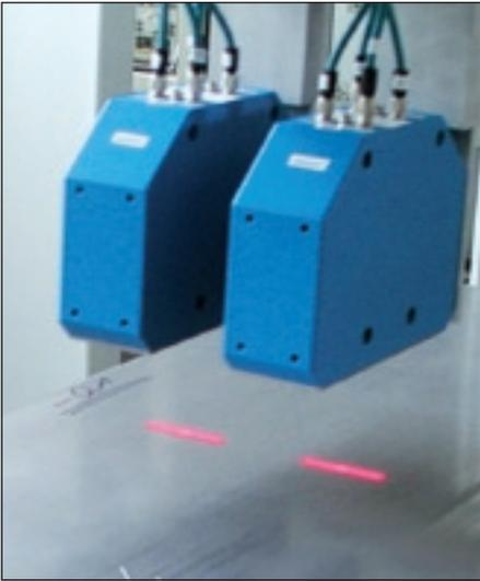
Herz der Blechprüfanlage – die speziellen Doppelsensorköpfe mit Lasertriangulation
