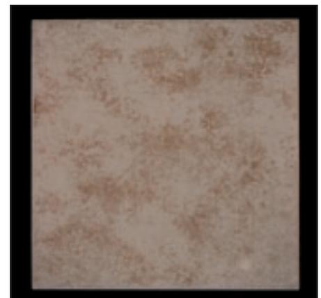
Abb. 3: Keramische Fliesen mit einem für das menschliche Auge problemlos erkennbaren Wassertropfen-Fehler rechts unten
