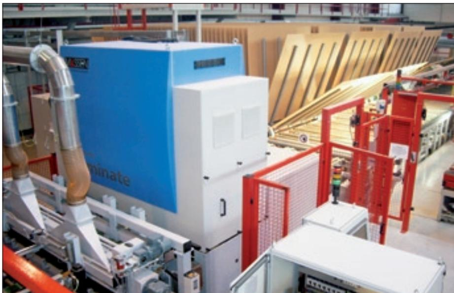
Abb. 6: Eine Inspektions-„Maschine“ für die beidseitige Inspektion von dekorierten Möbelplatten in der Produktionslinie
