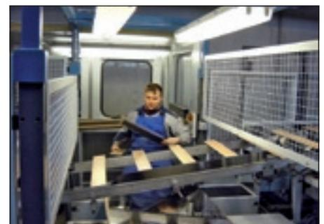
Abb. 1: Die vor wenigen Jahren noch ausschließlich manuell durchgeführte Inspektion von dekorierten Fußbodenlaminaten ist heute wegen der immer schneller arbeitenden Produktionsanlagen und der strengeren Forderungen an die visuelle Qualität nicht mehr möglich
