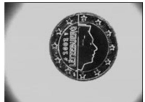
Abb. 4: Aufnahme einer Münze mit ringförmiger Beleuchtung zur Hervorhebung der Kanten
