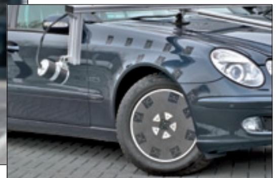
gänge aufgenommen werden können. Die Möglichkeit zur externen Triggerung gewährleistet eine zeitsynchrone Verknüpfung mehrerer Kameras untereinander oder mit anderen Sensoren. Durch das neue TraceCam F Messobjektiv beträgt der Abstand zwischen Kamera und Karosserie weniger als 500 mm.
