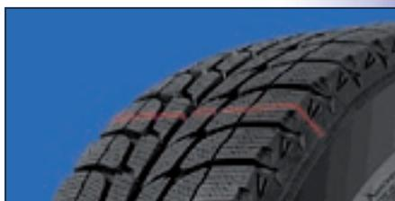
Ein Profil, viele Informationen: Die Profilform hilft bei der Identifikation des Reifentyps, der Soll-Ist-Abgleich des Profils deckt auch kleinste Profilfehler auf, Profilaussendurchmesser und Tiefe sind weitere Gütegrade im Prozess
