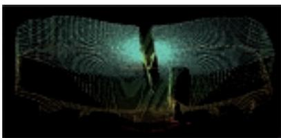
Herkömmlich werden Bremsbeläge von Kraftfahrzeugen mechanisch, z. B. mit Bügelmessschrauben vermessen. Die Messgenauigkeit ist häufig bedienerabhängig. Außerdem wird der Bremsbelagträger mitgemessen und dessen Dicke muss nachträglich abgezogen werden. Auf der Control
