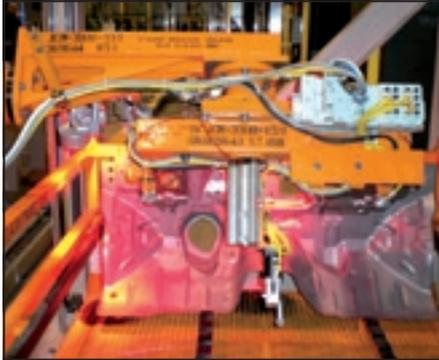
Wo Qualität und Effizienz von hochautomatisierten Roboter- und Handlingsystemen durch schnelle und präzise Positionsbestimmung gesteigert werden soll, kommt die 3D-Projektionsmesstechnik zum Einsatz. Das 3D Form Matching verbindet Roboterführung und Inline-Messtechnik mithilfe von Mehrlinien-Projektionssensoren und integrierter Flächenbeleuchtung.
