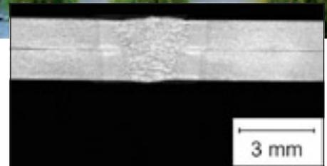
Abb.1: Schnittdarstellung einer lasergeschweißten Überlappverbindung von zwei 1mm starken Blechen
