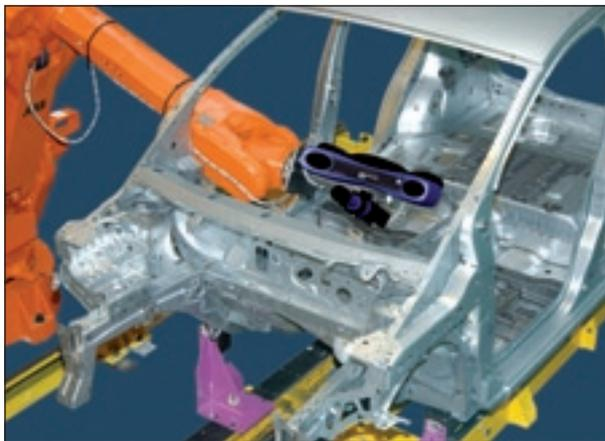
Objektive für ein Bildverarbeitungssystem an einem Roboterarm
