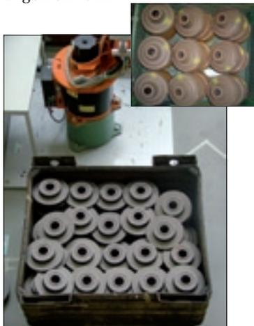
Robotergestützte Entnahme unbehandelte Bremsscheiben
