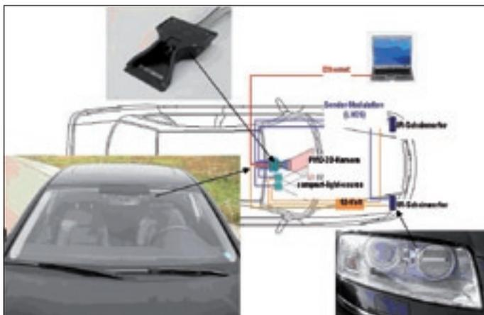
Abb. 1: Komponenten eines PMD-Systems und deren beispielhafte Fahrzeugintegration für Außenraumapplikationen im Frontbereich
