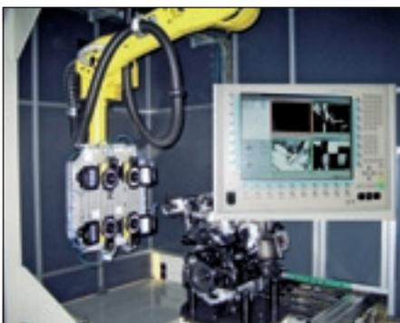
Gleichzeitig vier Vision-Sensoren der Produktfamilie In-Sight 5000 übernehmen am Roboterarm die Vollständigkeitskontrolle der Motoren
