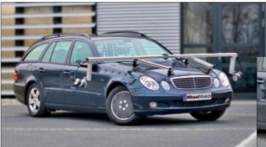
▲ Bereit für den Fahrversuch: Montiertes WheelWatch Messsystem
