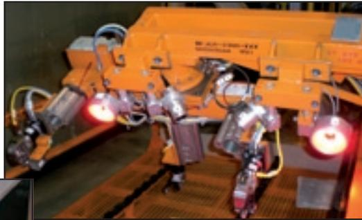
Automatisierte Entstapelung von Pressteilen im Rohbau
