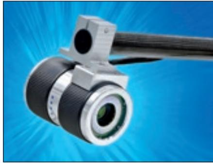
▲ Aicons WheelWatch basiert auf dem TraceCam F Kamerasystem, das ohne mechanische Kopplung mit dem Rad arbeitet
