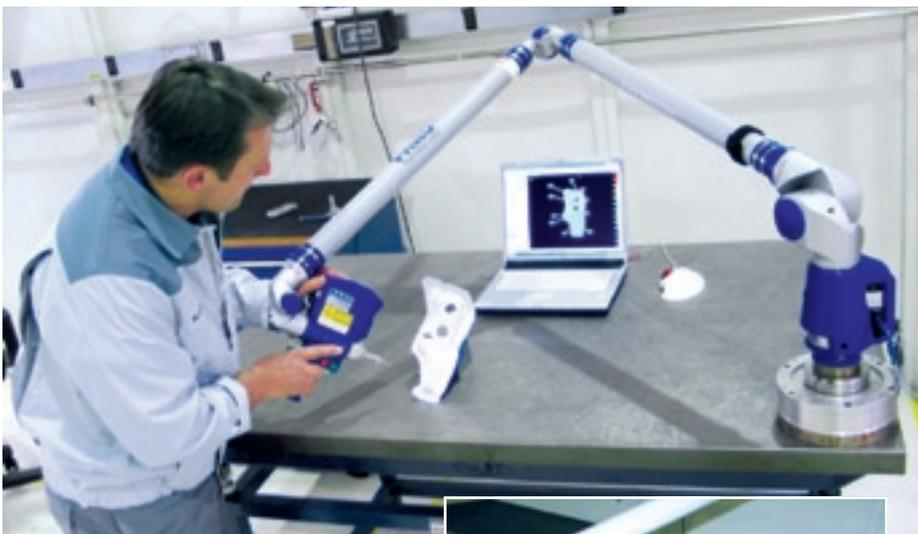
**Großer Nutzen für die tägliche Praxis: taktile und optische Messungen können mit einem Messaufbau durchgeführt werden**
