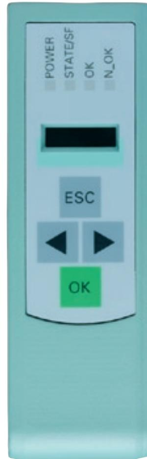
Die integrierte Bedieneinheit und die „Teach in“-Funktion verkürzen die Inbetriebnahmen und vereinfachen die Bedienung des Höhenprofilsensors Simatic MV230
