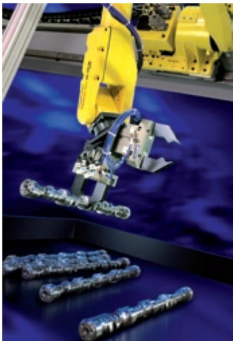
▲ Als T-Modell an einer Linearachse bleibt der Arbeitsraum unter dem Roboter frei, so dass er die ganze Beweglichkeit aus dem integrierten Visionsystem nutzen kann
