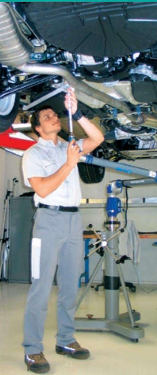
Der FaroArm kommt regelmäßig bei Messungen unter dem Auto zum Einsatz, wie hier beim Vergleich der Mess- mit den CAD-Daten an der Abgasanlage
