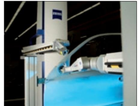
Der Laser-Linienscanner EagleEye: Mehr als 20.000 Punkte pro Laserlinie garantieren höchsten Informationsgehalt
