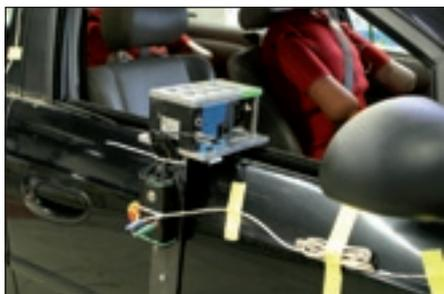
Hochgeschwindigkeitskamera SpeedCam MiniVis im Einsatz
