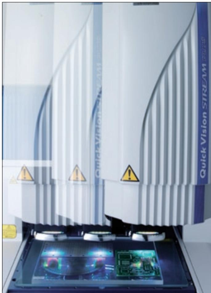
Bei der Messung „On-the-fly“ erfolgt die Messwertaufnahme während der Bewegung, sozusagen beim „Überfliegen“ der Messposition
