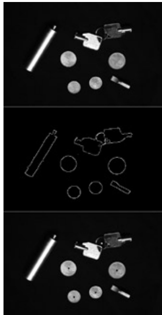
Abb. 4: Graustufenbild (oben), Kantenbild (Mitte) und Ergebnis der Hough-Transformation für Kreise (unten); eingeblendet in das Originalbild sind als Punkte die Mittelpunkte der gefundenen Kreise. Auch der teilweise verdeckte Schlüsselring wird gefunden.
