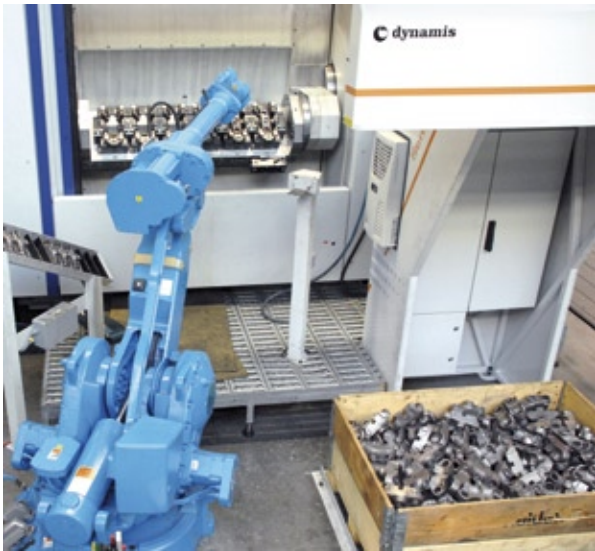
Dynamis AB, SenseActive Bin Picking Lösung
