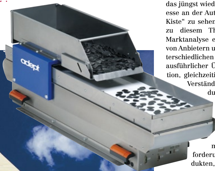
Der Adept AnyFeeder ist die flexible Zuführlösung für alle Kleinteile im Schüttgut
