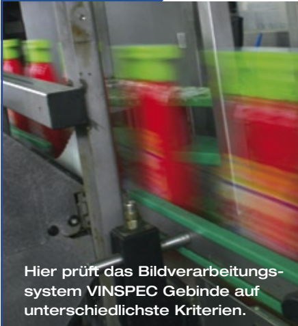
Produktionsanlage für Gesichtspuder, komplett mit automatisierter Zuführung und Bildverarbeitung (Quelle: Vetraco Gruppe)
