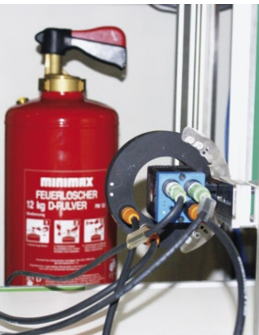
Das Vision-System Eyesight Advanced von SensoPart identifiziert Feuerlöschbehälter anhand verschiedener Geometrie- und Farbmerkmale. Für die optimale Belichtung sorgt dabei ein LED-Ringlicht.
