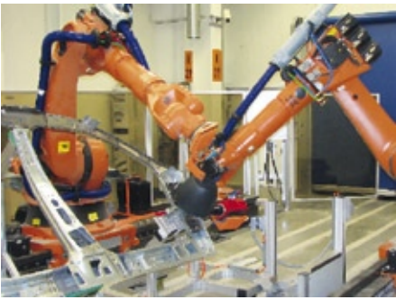
Automatisierte Thermographie-Prüfanlage von InfraTec zur zerstörungsfreien Prüfung von Karosserieteilen für die Automobilindustrie
