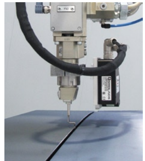
Eine spezielle Hakenapplikationsdüse ermöglicht die Nahtabdichtung direkt im Türspalt
