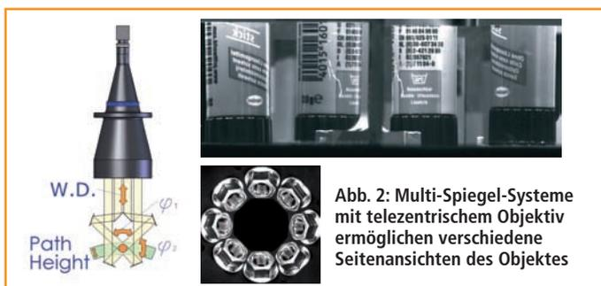
Abb. 2: Multi-Spiegel-Systeme mit telezentrischem Objektiv ermöglichen verschiedene Seitenansichten des Objektes
