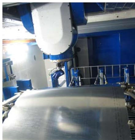
Zephyr scannt ein Teil des Airbus A380 Flugzeugrumpfs
