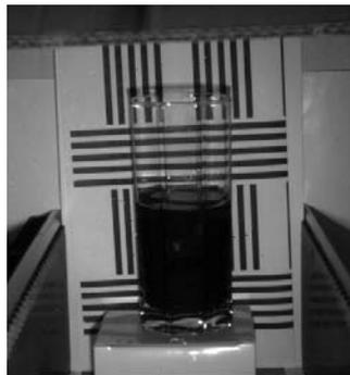
Wasserabsorption bei Lichtwellenlänge 1.300 nm (Laboraufnahme)
