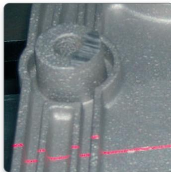
Beachten Sie **3dCast-Check**, unser stand-alone zerstörungsfreies 3D Prüfsystem, das rohe oder verarbeitete Gussteile auf den verschiedenen Oberflächen kontrolliert.
