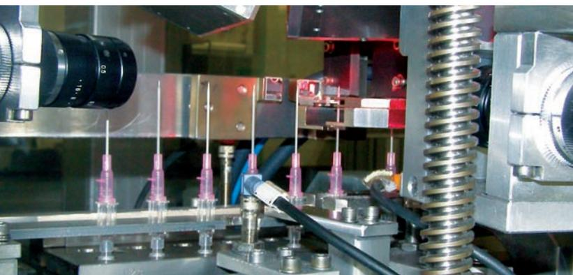
Vinspec prüft die Nadelspitzen in µm-Bereich
