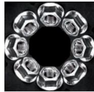
Abb. 3: PolyView-Objektive eignen sich, um sowohl Innen- als auch Außenflächen von Objekten wie Dichtungs-, Sicherungsringen oder Muttern abzubilden
