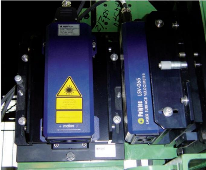
Anordnung der LSV-065 Messköpfe und der feinverstellbaren Justiereinrichtungen zur Messung der Translations- (linker Sensor) und Rotationsgeschwindigkeit (rechter Sensor) am Rohr
