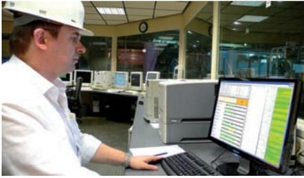
Hydro, ein europäischer Aluminiumkonzern, realisiert ein umfassendes Qualitätsmanagement in seinem Werk Grevenbroich. Dazu stützt das Unternehmen zwei Prozesslinien mit Oberflächeninspektionssystemen von Cognex und einer Qualitätsbewertungssoftware von QinLogic aus. Die Inspektionssysteme prüfen die Qualität der produzierten Bänder vor dem Versand an den Endkunden. Die Bänder können jedoch nur dann zur Auslieferung freigegeben werden, wenn auch Qualitätsdaten aus den
