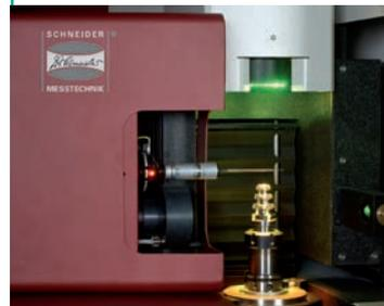
Schneider Messtechnik konzipierte und entwickelte seine neue Messmaschine WZM 600 speziell für die 3D-Werkzeugmessung. Sie verfügt über eine voll integrierte CNC-Drehachse sowie zwei getrennte Kamerasysteme: Eine radial ausgerichtete CCD Matrix Kamera für Auf- und Durchlichtmessung und eine
