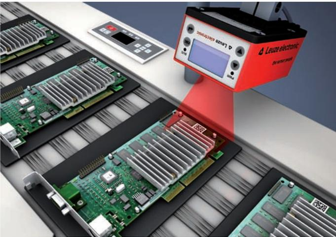
Abb. 2: Das Lesegerät LSIS 422i ist in der Lage, den gelaserten Data Matrix Code dieser Leiterplatte zu identifizieren
