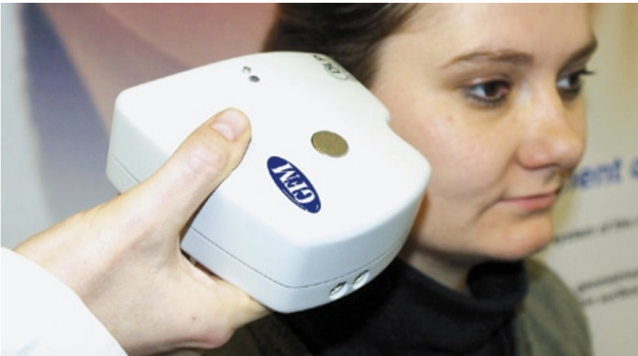
Optisches 3D in vivo Hautmessgerät PrimosPico
