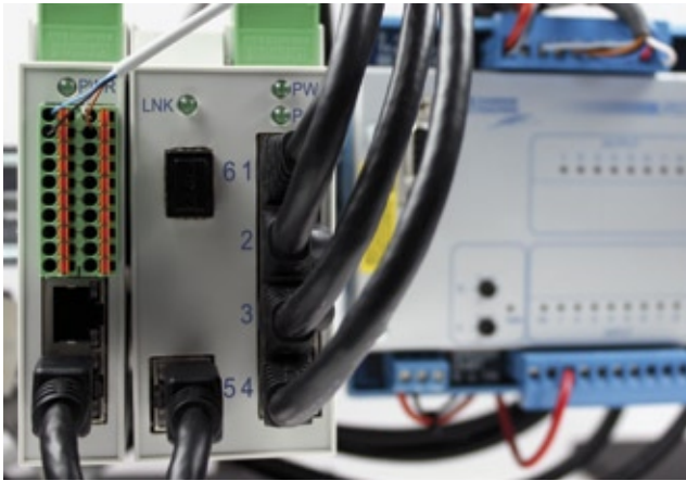
Einfache Integration auf Standard DIN Hutschiene
