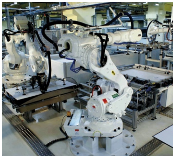
Vier Roboter kooperieren, um die Solarzellen zu Modulen zu verbinden
