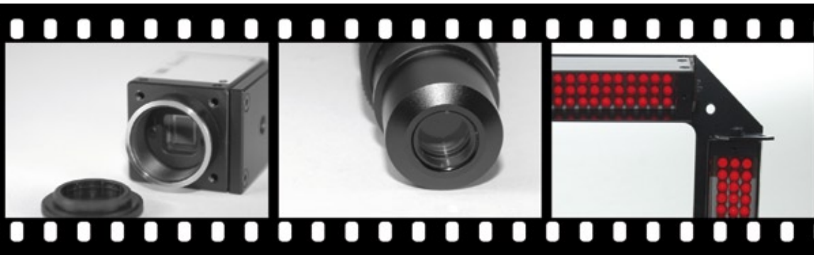
Abb. 1: Komponenten: Der Scanner besteht ausschließlich aus Standardkomponenten, wie einer konventionellen Industriekamera (links), einem Objektiv (Mitte) und einer Beleuchtung (rechts); die mechanischen Teile sind ebenfalls übliche Industriekomponenten.
