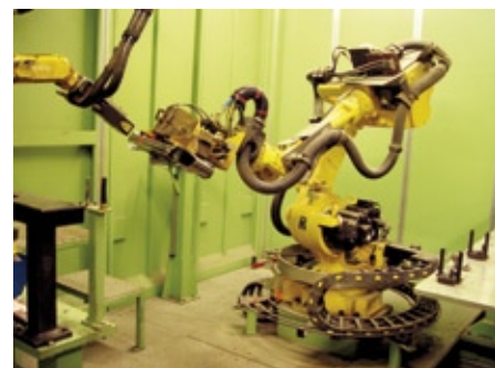
Die Inspektion der dreidimensionalen Schweißnähte bildet die Grundlage zur Prozessoptimierung sowie zur automatischen Nacharbeit (Quelle: Vitronic)
