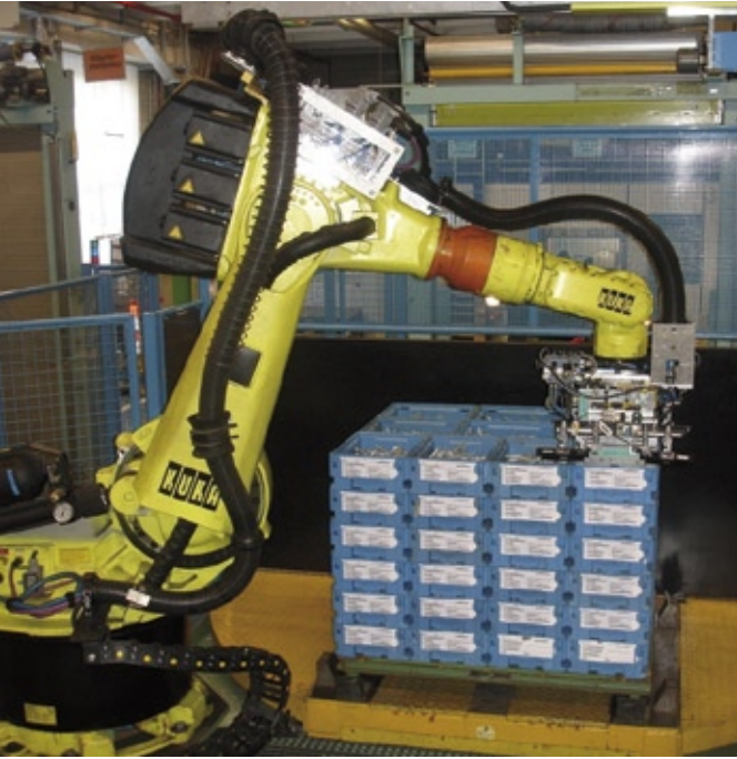
Ein Roboter depalettiert Kleinteileladungsträger völlig selbstständig
