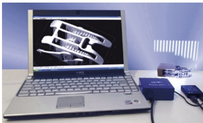
Das Pico DevKit, eine Entwicklungsumgebung für die digitale Lichtprojektion
