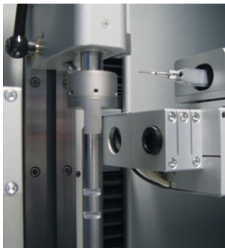
Zweckehe: Multisensormesssystem mit der Symbiose Taster, Optik und Beleuchtung
