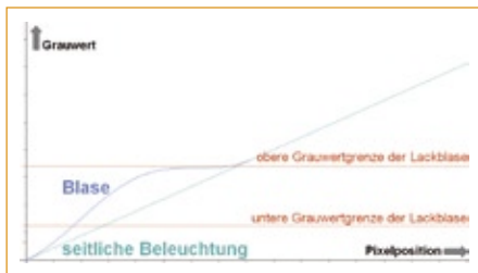
Abb. 4: Lackblase im Grauwertprofil bei unterdrückter Lackierung
