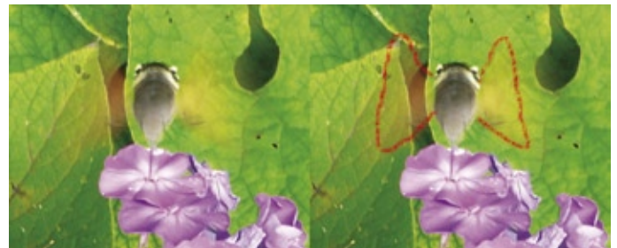
Abb. 2: Bildverschmierung bei einer „progressive-scan“-Kamera, hier erkennbar im Bereich der schnell bewegten Flügel des Schmetterlings; Belichtungszeit: 25 ms
