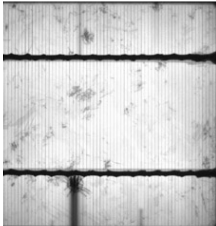
Schwarze Balken im unteren und oberen Teil der PV-Zelle weisen auf Unterbrechungen der aufgedruckten Fingerelektroden hin. Das Bild wurde bei 4 x 8 s Integrationszeit mit einer Andor Luca R Kamera aufgenommen (mit freundlicher Genehmigung von Dr. Karsten Bothe, IFS Hameln).
