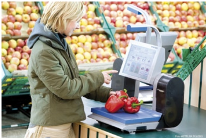
▲ Mithilfe der kompakten USB-Kamera wird das Obst auf der Waage erkannt
