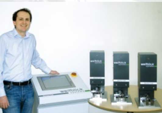
DI (FH) Rainer Reisinger, Geschäftsführer der weitblick systems, zeigt das automatische Messsystem mit den drei Messstationen und dem Steuergerät mit integriertem PC
