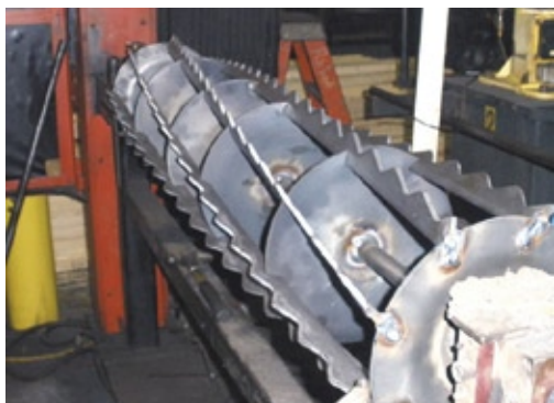
Abb. 3: An Ackerfräsen werden im Schutzgas-schweißverfahren 60 Schweißungen mit einer durchschnittlichen Länge von 35 mm ausgeführt
