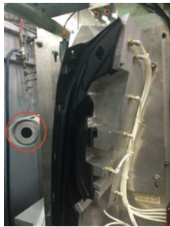
Vom Systemintegrator Emitted Energy an der IR-Schweißmaschine installierte Flir A315 Wärmebildkameras.
