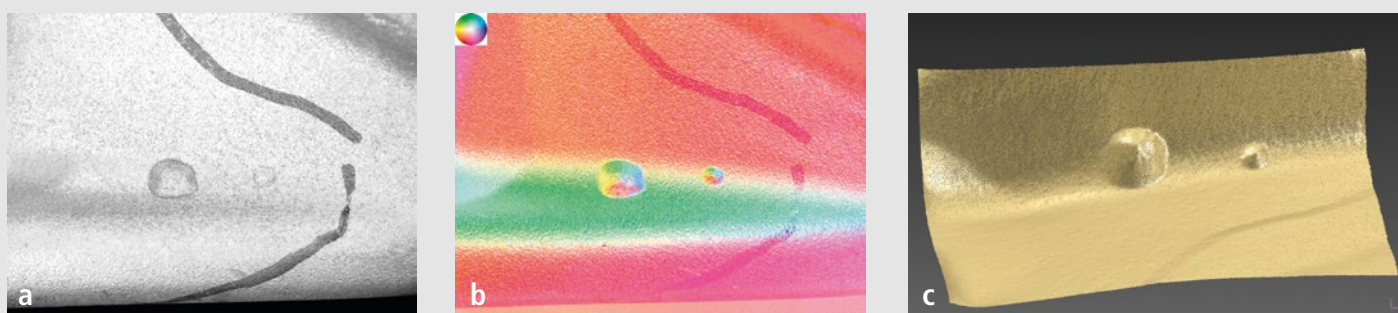
Abb. 3: Aus acht Beleuchtungen rekonstruiertes Albedo-Bild (a), farbkodierte Richtungen (b) und photometrische 3D-Rekonstruktion (c)
