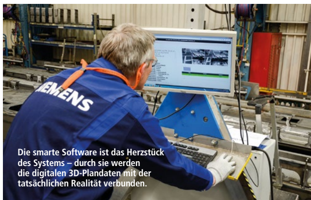
Werklicht Pro projiziert CAD-Informationen direkt auf Bauteile. Damit werden Schablonen überflüssig und der Einsatz von Koordinatenmessmaschinen wird reduziert.
