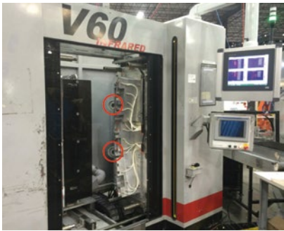
Vom Systemintegrator Emitted Energy an der IR-Schweißmaschine installierte Flir A315 Wärmebildkameras.
