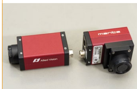
Die eingesetzte Manta-Kamera von Allied Vision – links im Seriengehäuse, rechts modifiziert für Carl Zeiss Optotechnik
