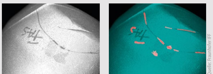
Abb. 6: Die Detektion von Falten (r.) basiert auf einem morphologischen Verfahren zur Erkennung von Textur-Unregelmäßigkeiten und einer Klassifikation anhand des Reflexionskoeffizienten aus dem Albedo-Bild (l).
