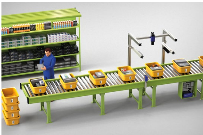
Inhaltskontrolle von Behältern mit Gegenprobe zum angebrachten Barcode
