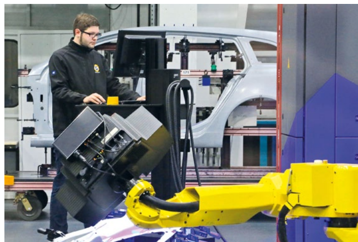
Über eine vereinfachte Benutzeroberfläche kann der komplette Messablauf vom Produktionspersonal gesteuert werden.
