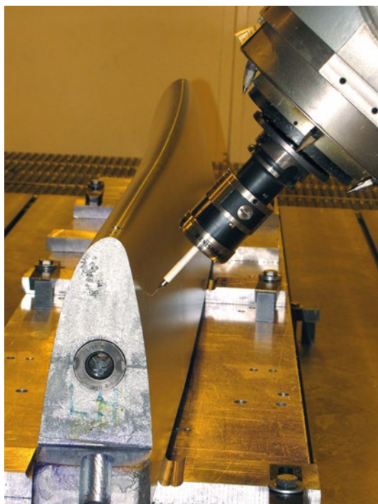
Die patentierte Renegade-Technologie ermöglicht Messungen aus jeder Richtung mit einer Einmal-Kalibrierung. Die Messroutine wird mit der OMV Pro Software offline programmiert und auf einer Siemens 840D CNC ausgeführt. Die Ergebnisse werden offline auf einem PC ausgewertet.
