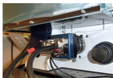
Die Hochgeschwindigkeitskamera ist über einen Rotationsadapter mit dem Mikroskop verbunden. So lässt sie sich drehen, falls der Messbereich im Chip nicht mit dem Kamerachip parallel liegt.
