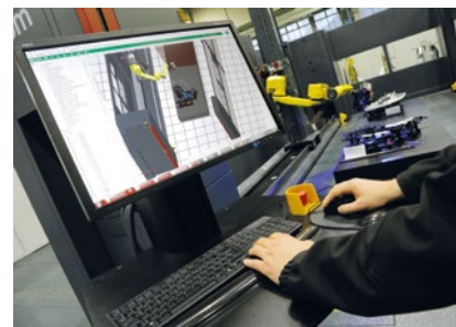
Im Virtuellen Messraum wird die 3D-Koordinatenmessmaschine inklusive Bauteile und Kinematik simuliert.
