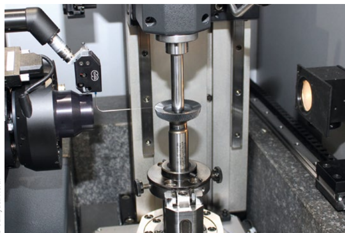
Abb. 2: Der Werth Fasertaster ermöglicht u.a. das Messen des Flankenhinterschliffs bei Schälrädern.
