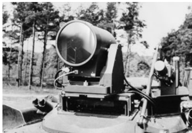
Abb. 2: Infrarot-Sicht für einen Kampfpanzer. Der Entwicklungsvertrag wurde 1958 unterzeichnet.
