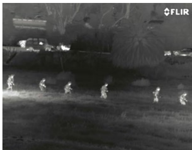
Abb. 1: Wärmebildkameras können in völliger Dunkelheit sehen und benötigen keinerlei Restlicht.
