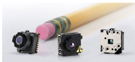
Abb. 7: Der Lepton von Flir ist ein extrem kompakter, langwelliger Infrarot-Imager (LWIR), der 10-mal günstiger als herkömmliche Wärmebildkameras ist.
