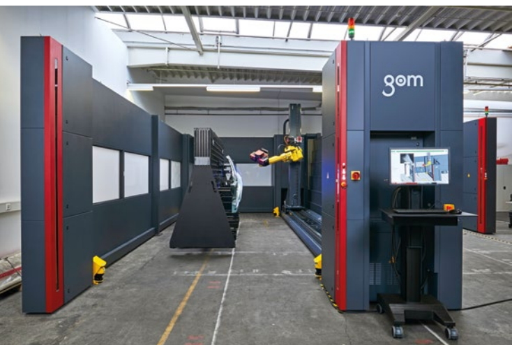
Atos Scanbox 7260 – optische 3D-Koordinatenmessmaschine für große Bauteile
