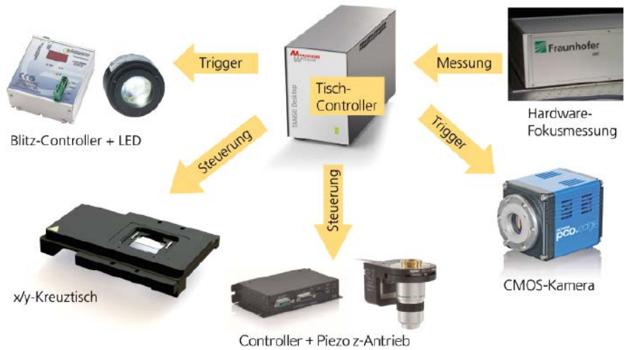
Abb. 3: Prinzipieller Aufbau des modularen Hochgeschwindigkeitsmikroskops
