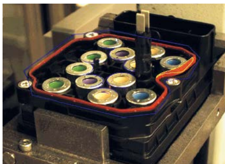
Abb. 7: Erkennung der nicht korrekten Position eines ECU Dichtrings
