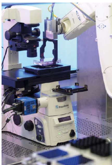
Abb. 2: Mit einem Hochdurchsatz-Mikroskopie-system können großflächige Objekte in Sekundenschnelle mikroskopiert werden. Erstmals ist so eine mikroskopische 100%-Prüfung im industriellen Umfeld möglich.
