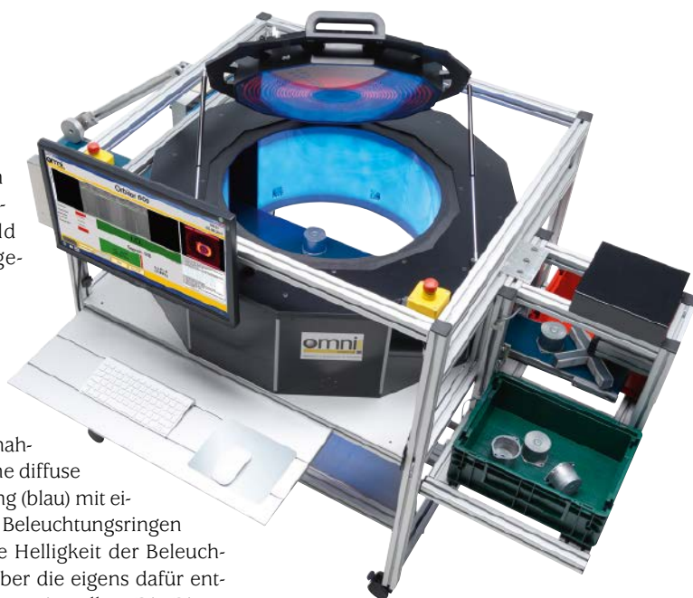
360°-Oberflächenkontrolle im Durchlauf auf nur 1m 2 mit dem Orbiter600
