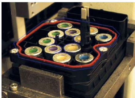
Abb. 6: Inspektion der korrekten Position eines ECU Dichtrings
