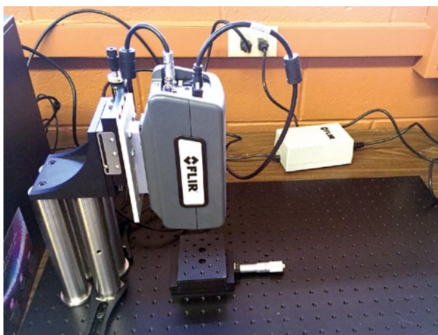
Bei einem typischen Testexperiment werden auf einem Substrat aufgebrachte Mikro-Heizdrähte mit einer Stromversorgungsquelle verbunden. Dann wird das Gerät mittels Joulescher Wärme (Stromwärme) erwärmt. Dadurch entwickelt sich das Temperaturfeld des Substrats als eine Zeitfunktion.
