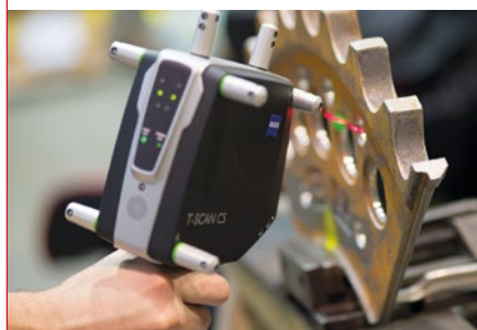
Der Zeiss T-Scan erfasst die Topographie des Werkstücks mit 210.000 Einzelpunkten pro Sekunde.
