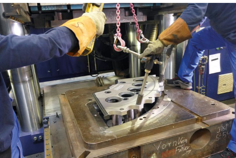
In der Vulkanisationspresse werden Gussteile und Gummi fest miteinander verbunden.
