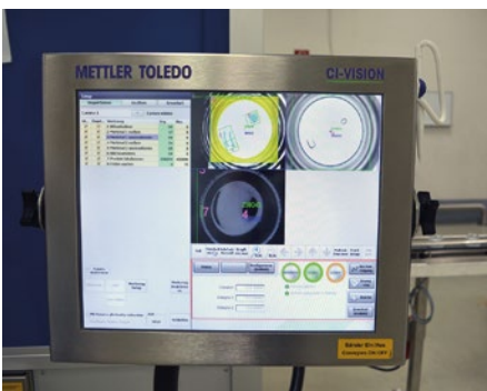
Das Statistikmodul des Mettler Toledo Inspektionssystems erkennt Fehlermuster und macht Bediener und Produktionsleiter auf häufige Fehler bei den Glastiegeln aufmerksam.
