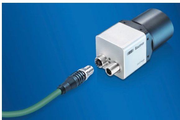
Der 8-polige X-codierte M12-Stecker stellt durch die Verschraubung und den IP-Schutz eine zuverlässige Verbindung für das Dateninterface sicher.
