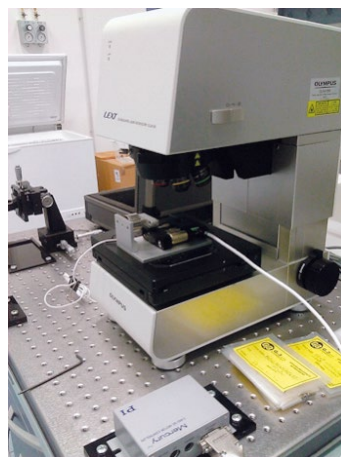
Abb. 1: Testgerät zur Bestimmung der Mikrozugfestigkeit, gekoppelt mit dem Lext OLS4100. Das modulare Mikrozugfestigkeits-Testgerät passt auf den Tisch des Lext. In 5%-Schritten wird die Belastung gesteigert und nach jedem Schritt werden Bilder aufgenommen.
