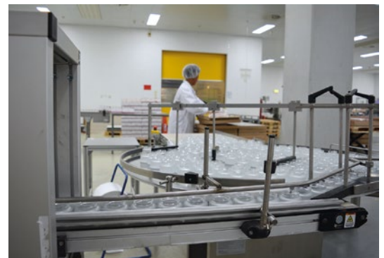
Automatisierte optische Inspektionslösung von Mettler Toledo CI-Vision zur Untersuchung von Glastiegeln beim Kosmetik-Produzenten Maxim
