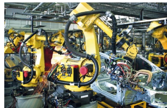
Abb. 1: Voll automatisierte Fertigungsstraße für Fahrzeugkarosserien
