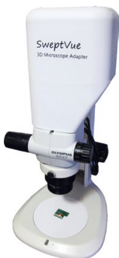
Abb. 2: Das SweptVue ist ein neuartiger Stereo-Mikroskopadapter, der die schnelle und auf wenige Mikrometer genaue Erfassung von kleinen Objekten in allen drei Dimensionen möglich macht.
