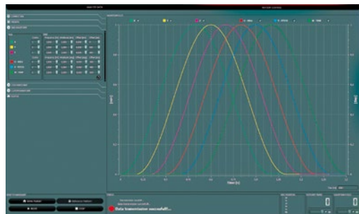
Abb. 5: Für jeden der sechs Freiheitsgrade kann ein Sinus oder eine kundenspezifische Bewegung mit unterschiedlicher Frequenz und Amplitude definiert werden.
