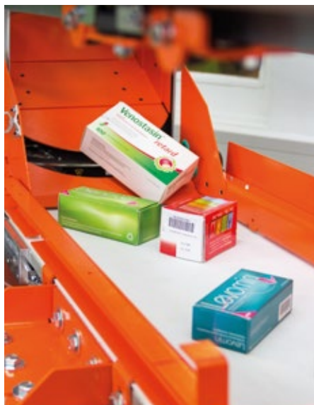
Die Vereinzelung der Medikamentenpackungen erfolgt über ein Förderband, wo ein Lichtschnittsensor LPS 36 die Packungen im Durchlauf detektiert.
