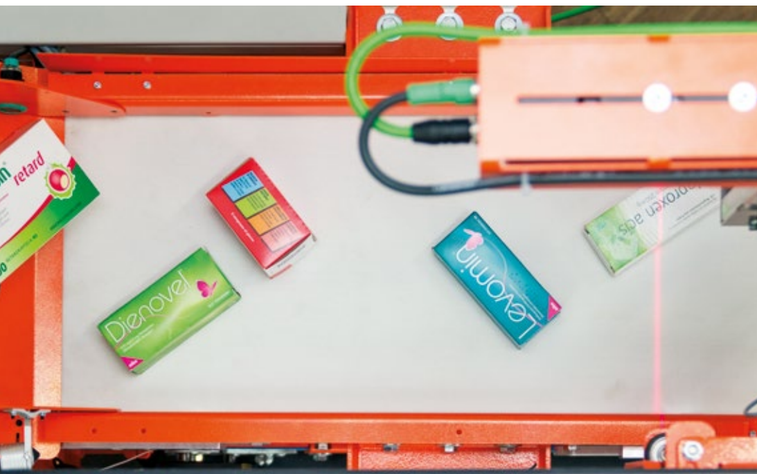
Mit den vollautomatisierten Einlagerungsmodulen der Gollmann Kommissioniersysteme können Warenlieferungen unsortiert einfach in einen Behälter gekippt werden.
