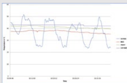
Abb. 3: Temperaturverlauf während des Gusses. Die Temperatur „Aussen“ zeigt jeweils einen Anstieg, wenn die Brücke mit den Brennschneidern über den Strang fährt.
