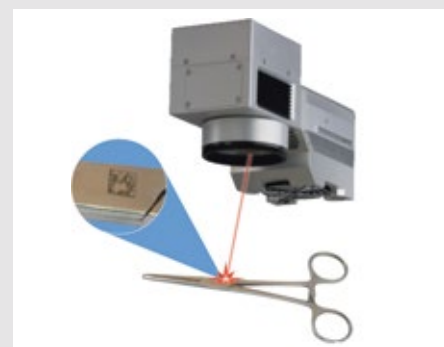
Abb. 3: Schematische Darstellung der direkten Laserkennzeichnung eines chirurgischen Instrumentes
