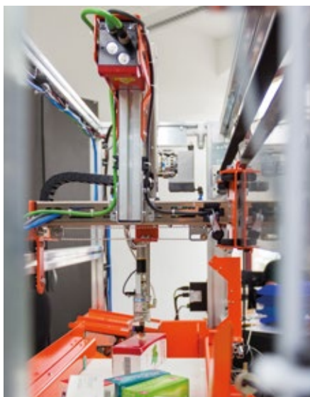
Mit den ermittelten 3D-Koordinaten der Medikamentenschachteln kann das Handlingsystem im Einlagerungsmodul die Packungen richtig und schonend aufnehmen und in das Übergabefach des Kommissionierautomaten ablegen.
