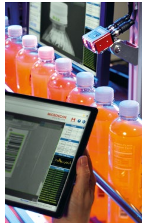
Eine webbasierte Benutzerschnittstelle zeigt Inspektionsdaten von einem Machine-Vision-System auf der Fabrikationsebene und erlaubt Inspektionen, angezeigt per Webbrowser, auf jedem lokalen Gerät.
