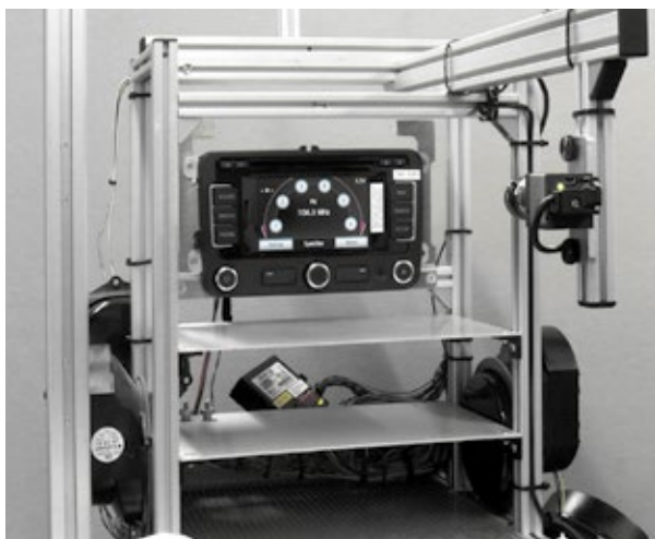
Optisches Inspektionssystem, das jeden einzelnen Bildschirminhalt der Infotainment-Systeme zur Texterkennung und Verifizierung abfotografiert
