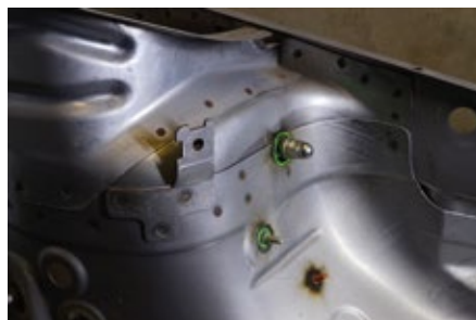
Das Laserprojektionssystem wird bei SD Automotive im Rahmen eines aktuellen Projektes zum Bolzenanreißen eingesetzt.
