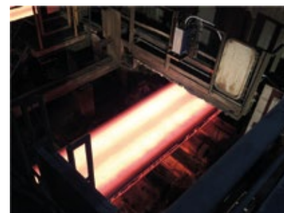
Abb. 2: Position des Messsystems über dem Strang. Vorne links ist ein Teil der Brücke mit den Brennschneidern zu sehen.
