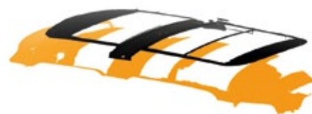
Wie viel Platz haben wir? Scans von Dach und Himmel: Bauraumanalysen geben Aufschluss bei fehlenden CAD-Daten.
