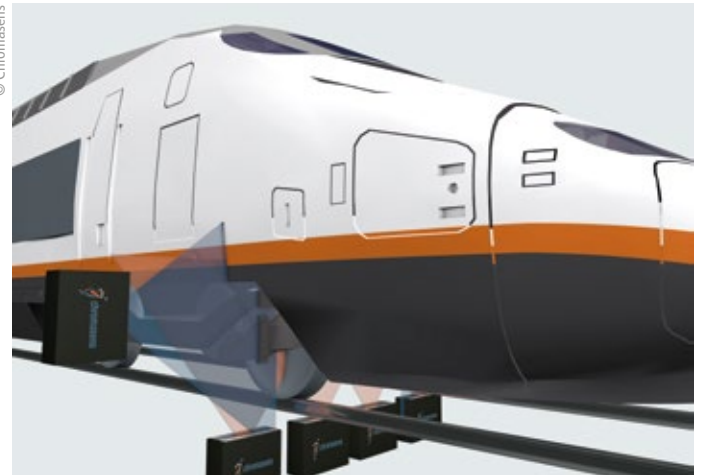
Bei dem neu entwickelten Inspektionsverfahren sorgen sechs hochauflösende 3D-Zeilencameras mit überlappender stereoskopischer Bilderfassung für eine detaillierte Darstellung der Zugunterseite und der -seiten.
