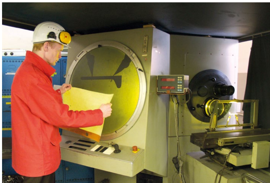
Abb.1: Manueller Vergleich der Profilform am Profiprojektor
