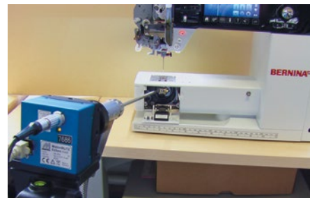
Mit der hochauflösenden High-Speed-Kamera und einem Endoskop können die Ereignisse im Mikrobereich an Nähmaschinen unmittelbar vor Ort genau untersucht werden.
