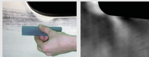
▲ Links: manuelles Abziehen eines Bauteils, rechts: Ergebnis des „virtuellen Abziehsteins“
