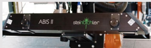
▲ Der robotertaugliche Sensor ist für die harten Bedingungen im Presswerk ausgelegt.
