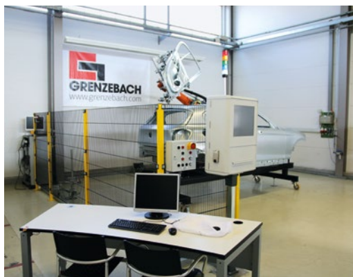
Zelle mit Panel PC mit Multi-Core Rechner, Schnittstellen, Klimagerät
