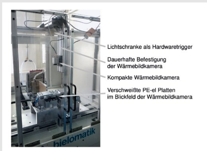
Abb. 1: Einsatz des mobilen Thermographie-Systems während eines Heizelementstumpf-schweißprozesses
