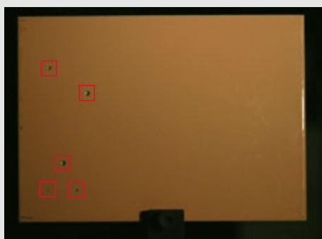
Probe mit seewasserbeständigem Schutzanstrich und verschiedenen künstlich angewendeten Stiftlöchern (links) sowie (unten) dem Wärmebild und den verarbeiteten Bildern mit diesen Stiftlöchern.
