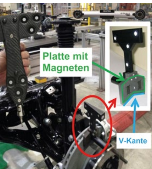
Abb. 2: Auch mit Hilfe eines einfachen Werkzeugs ist die automatische Ausrichtung möglich.
