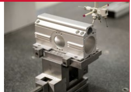
Der Scanningmesskopf Zeiss XTR lässt sich immer im richtigen Winkel zum Bauteil positionieren.
