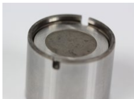
Abb. 1: Der zu vermessende Tassenstößel. Der maximale Höhenunterschied der einzelnen Messpunkte liegt bei knapp 3,1 mm.
