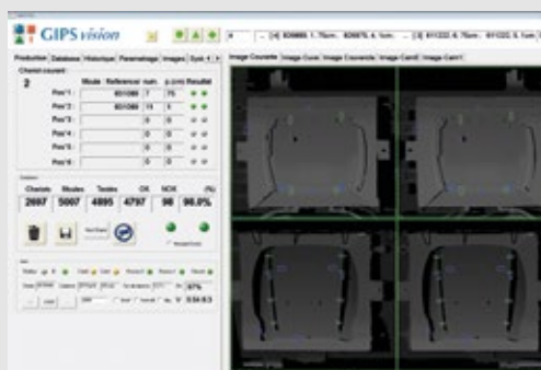
Die grafische Benutzeroberfläche des Systems zeigt Bilder und Auswertungen der geprüften Objekte.
