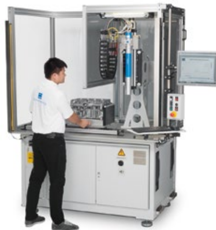
Der Hommel-Etamic IPS B100 ist auf die Qualitätskontrolle von Zylinderbohrungen in Kurbelgehäusen zugeschnitten.
