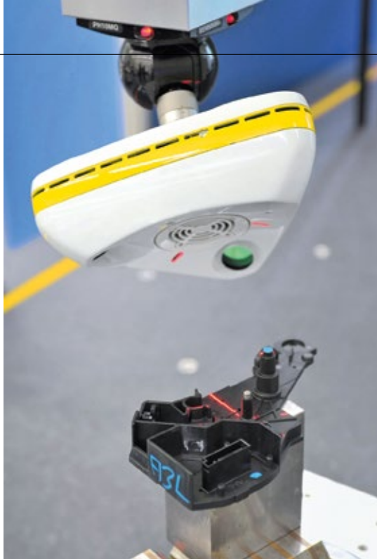
Abb. 3: Der digitale Cross-Scanner erzeugt drei Laserlinien unter verschiedenen Winkeln, um komplexe Formen mit einer minimalen Anzahl von Rotationen des Messkopfes zu messen.
