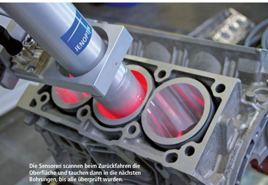
Je nach Taktzeit tauchen ein bis sechs Sensoren in die Bohrungen ein.
