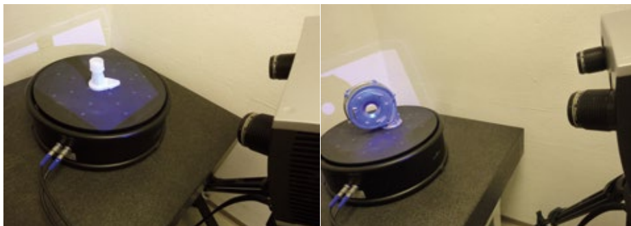
Steinbichler Comet L3D 5M und Rotationstisch Cometrotary zur automatisierten Positionierung
