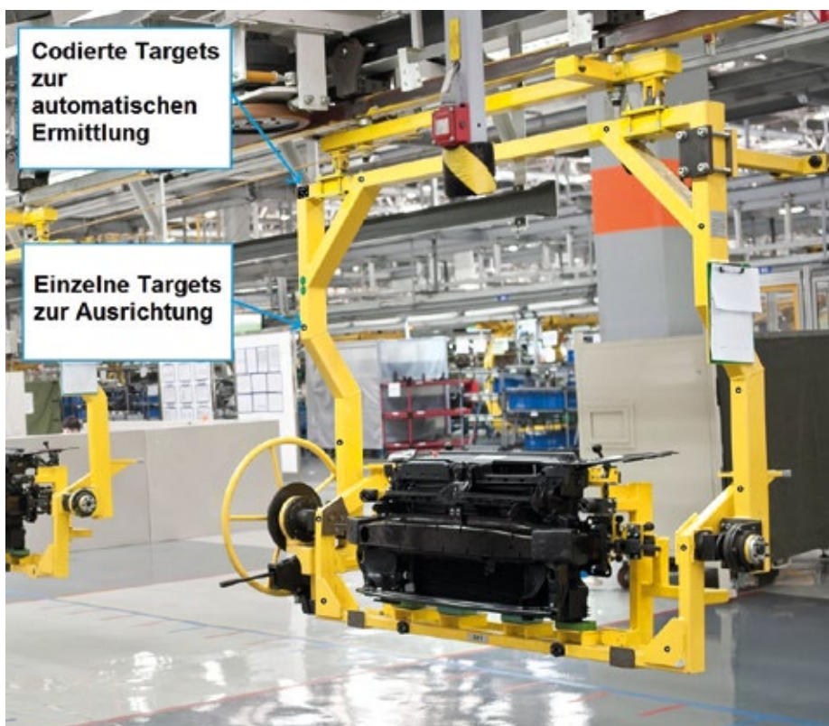
Abb. 1: Montagegestelle mit verschiedenen Target-Mustern und Ausrichtungspunkten
