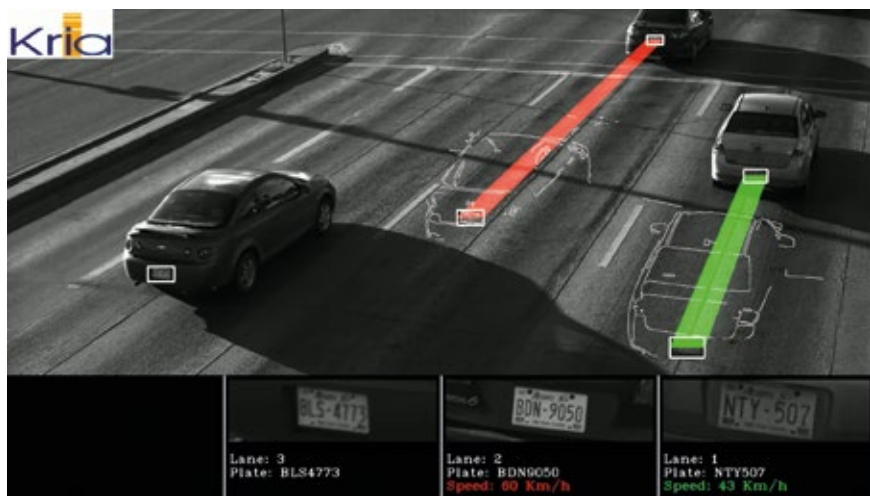
Mit einem Kamerasystem lassen sich auf 4 Spuren die Fahrzeuggeschwindigkeit messen und Kennzeichen erkennen.
