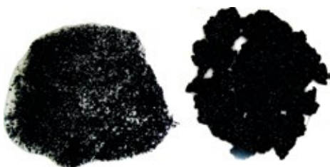
Abb. 1: (links) Eine schlecht entwässerbare Flockung: - hohe Anzahl an Kleinflocken (Flockenlänge < 100 Pixel) (rechts) Eine gut entwässerbare Flockung: - keine Kleinflocken (Flockenlängen > 100 Pixel)
