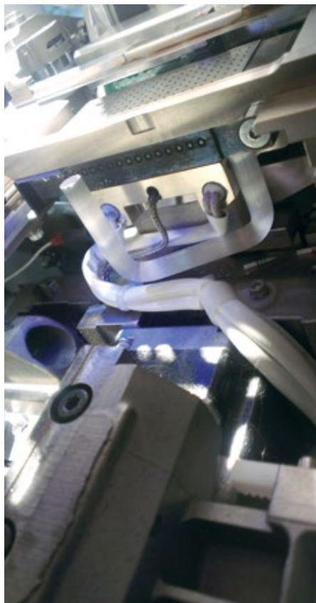
Abb. 1: Die Unterseite der Streifen vor dem Drahtbenden mit der Position des zweidimensionalen Matrix-Codes. Der Code kennzeichnet den Streifentyp und damit auch das Layout des MEMS-Bauteils.
