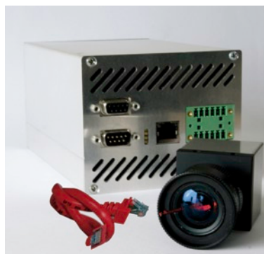
Kostengünstige Verkabelung mit Ethernet Patch-Kabeln
