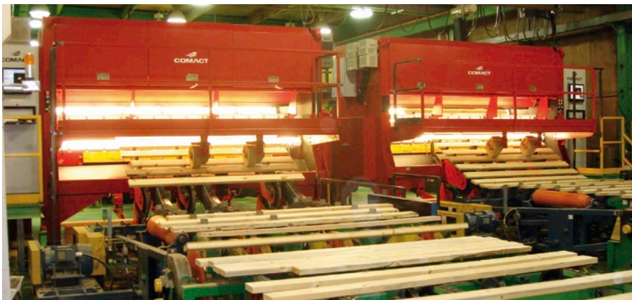
Abb. 3: Diese Sägemühle verwendet ein optisches Erkennungssystem bei der Entscheidung über die Aufteilung von Schnittholz in fehlerlose Standardlängen bei gleichzeitiger Maximierung verwertbaren Materials (mit freundlicher Genehmigung von Comact)
