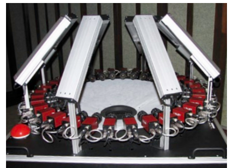
Diese Messedemo verdeutlicht den Aufbau eines Daisy-Chain-Netzwerks mit direkter FireWire-Verbindung von Kamera zu Kamera
