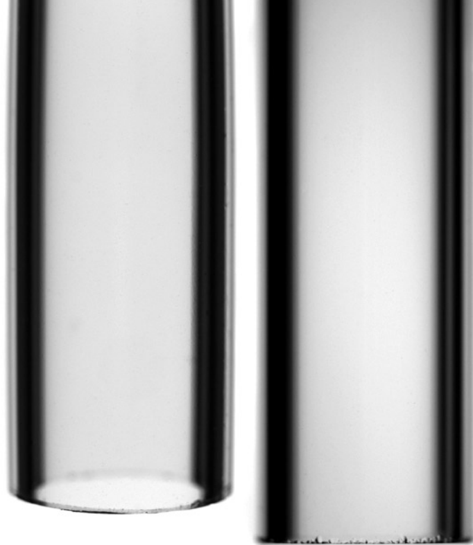
Vergleich von entzentrischen (links) und telezentrischen (rechts) Objektiven: Die Produktkante erscheint bei entzentrischen Objektiven elliptisch verzerrt. Bei telezentrischen Objektiven erscheint die Kante als gerade Linie
