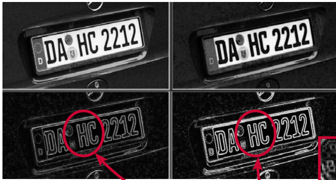
Abb. 2: Graustufenbild, dilatiertes Graustufenbild (oben) und Ergebnis der Differenzbildung (links unten); zum Vergleich rechts unten Ergebnis einer Sobel-Filterung mit Detailausschnitt aus den Kantenbildern
