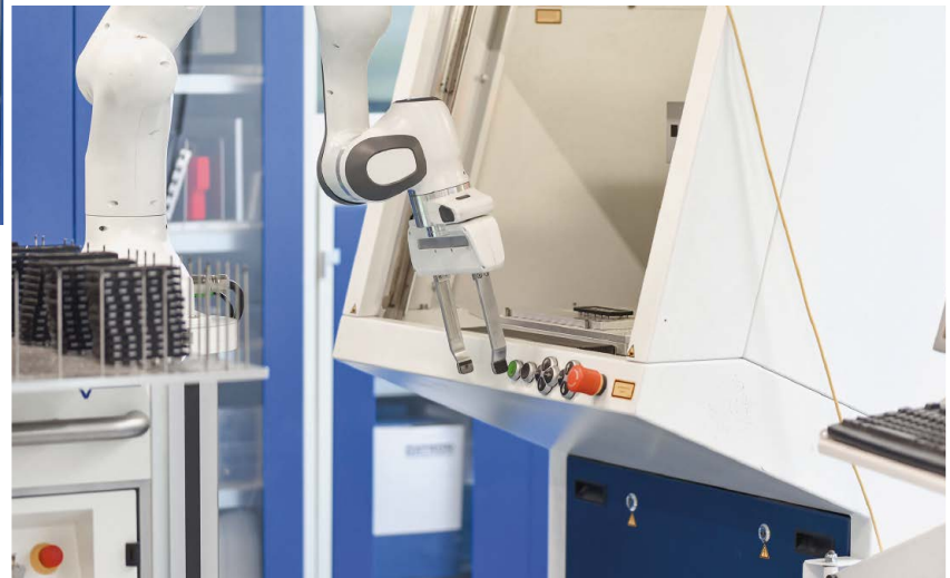
Rund um die Uhr im Dienst: Kollaborierende Roboter bedienen die CNC-Maschinen (links) und starten sie auch (unten).
