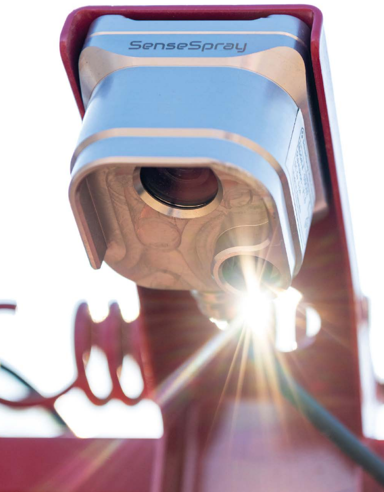
Das SenseSpray-System erkennt mithilfe von Kameras Unkraut in Echtzeit und aktiviert nur dort die Sprühdüsen, wo eine Behandlung nötig ist, wodurch der Chemikalienverbrauch um bis zu 90 Prozent gesenkt wird.
