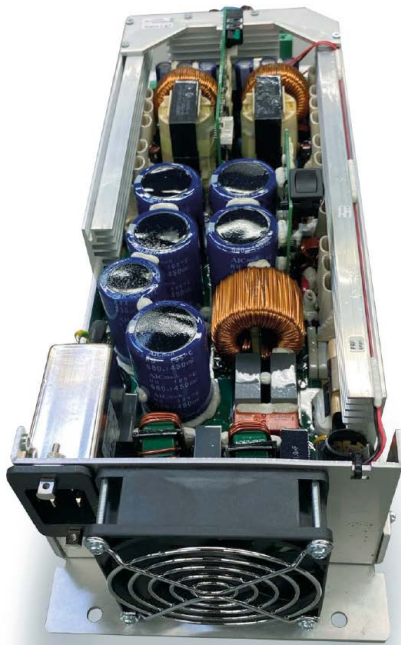
Für das SIS eines großen Herstellers entwickelte Eplax ein Schaltnetzteil, dessen Ausfallsicherung unter anderem mit Kühlkörpern von CTX gewährleistet wird.
