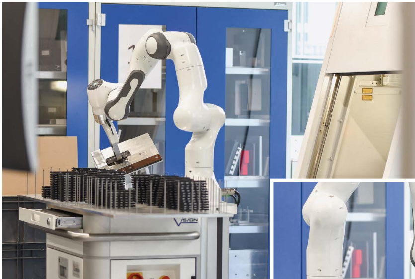
Rund um die Uhr im Dienst: Kollaborierende Roboter bedienen die CNC-Maschinen (links) und starten sie auch (unten).
