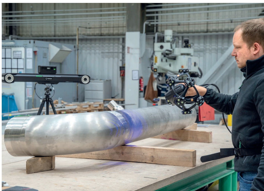
Mit der Unterstützung von handgeführten 3D-Scannern erweitert Hexagon den Einsatzbereich von Bendingstudio XT auf kleinere Metallbau- und Fertigungsbetriebe. Damit erhalten sie dieselbe Messmethodik und Auswertungslogik wie Großserienproduzenten.
