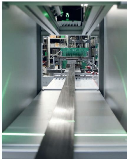
Der entwickelte Demonstrator erkennt bei Produktionsgeschwindigkeiten bis zu zwei Metern pro Minute Abweichungen der faserverstärkten Profile von weniger als 100 Mikrometern.
