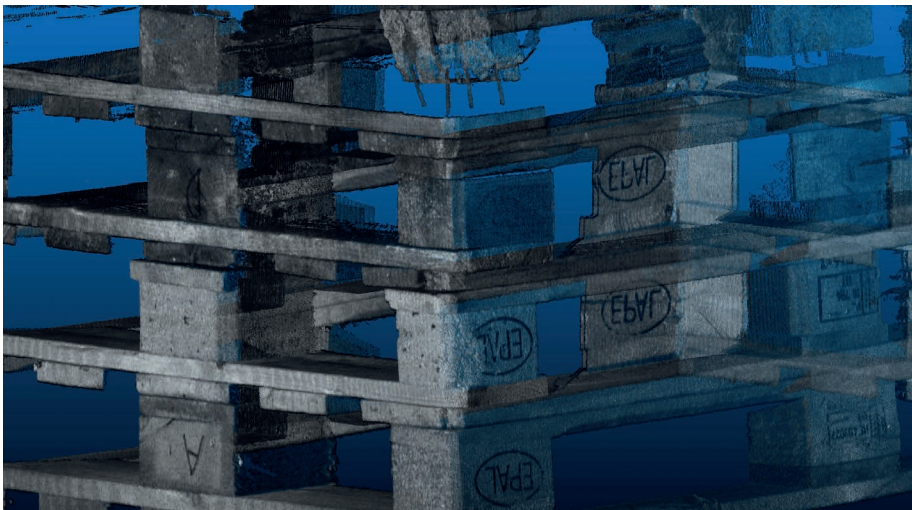
Die Datenerfassung mittels Laserscanner liefert einen digitalen Zwilling, der die Grundlage für die Beurteilung der aufgenommenen Palette bietet.
