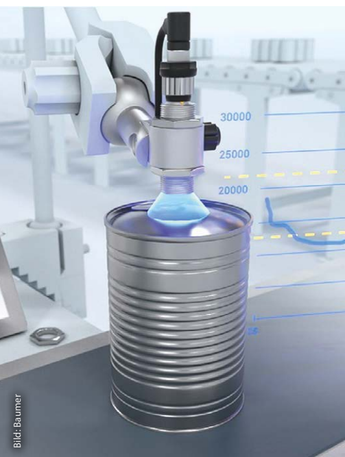
Für den Qualitätscheck der Katzenfutterdosen werden distanzmessende Induktivsensoren mit IO-Link eingesetzt.
