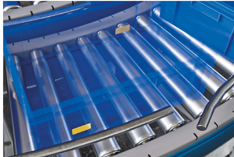
Diagonal an gegenüberliegenden Seiten aufgeklebte RFID-Tags sorgen dafür, dass sich mindestens ein Tag in Reichweite eines Lesegeräts befindet.
