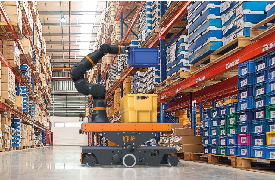
Igus setzt auf bewährte Low-Cost-Automation-Technik aus dem eigenen Haus und kombiniert Cobot und AMR.
