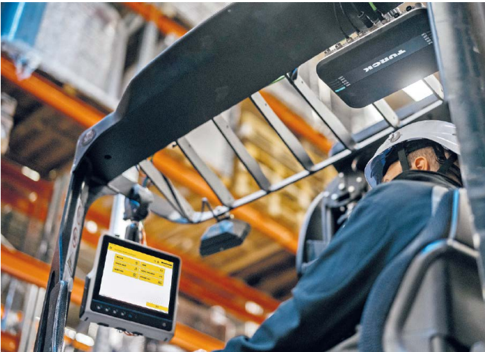
Mit UHF-Readern und Displays auf Gabelstaplern gibt es auch beim Transport mehrerer Behälter in der Produktion oder im Lager keine blinden Flecken mehr.
