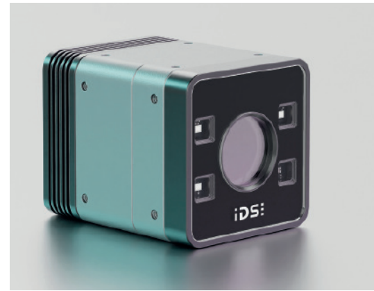
Die Nion: eine kompakte 3D-TOF-Kamera in Schutzart IP67
