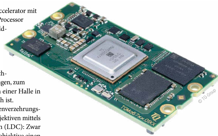
Das Embedded-Modul TQMa67xx verfügt neben zahlreichen Kamera- und Sensoreingängen auch über die entsprechenden Bildverarbeitungsbeschleuniger.
