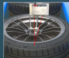
Geometrieprüfung von Reifen
