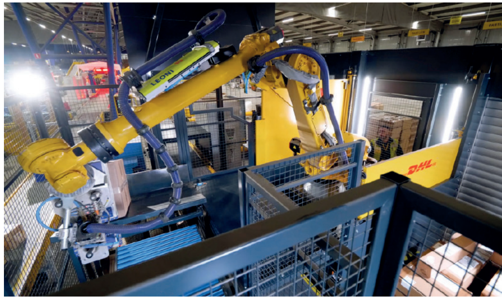
Der robotergestützte Depalettierer Rode legt Pakete auf das Sortierband. Er dreht sie dabei, dass die benötigte Längsseite des Pakets nach vorne zeigt. Zwei Ensenso-3D-Kameras von IDS liefern die Bilddaten.
