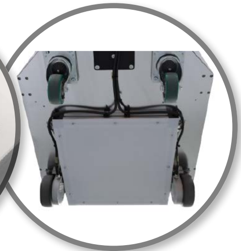
SensorBoard für die selbständige Standorterkennung und Auswahl des passenden Roboterprogramms
