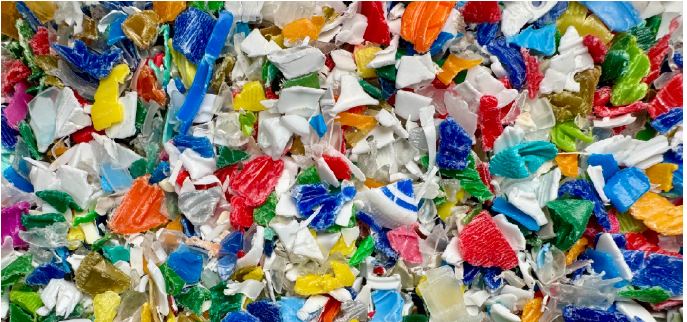
Hier sind im Inputmaterial vier verschiedene Kunststoffe enthalten: PE-, PET-, PP- und PS-Flakes. Diese sollen ihrer Materialart entsprechend sortiert werden.
