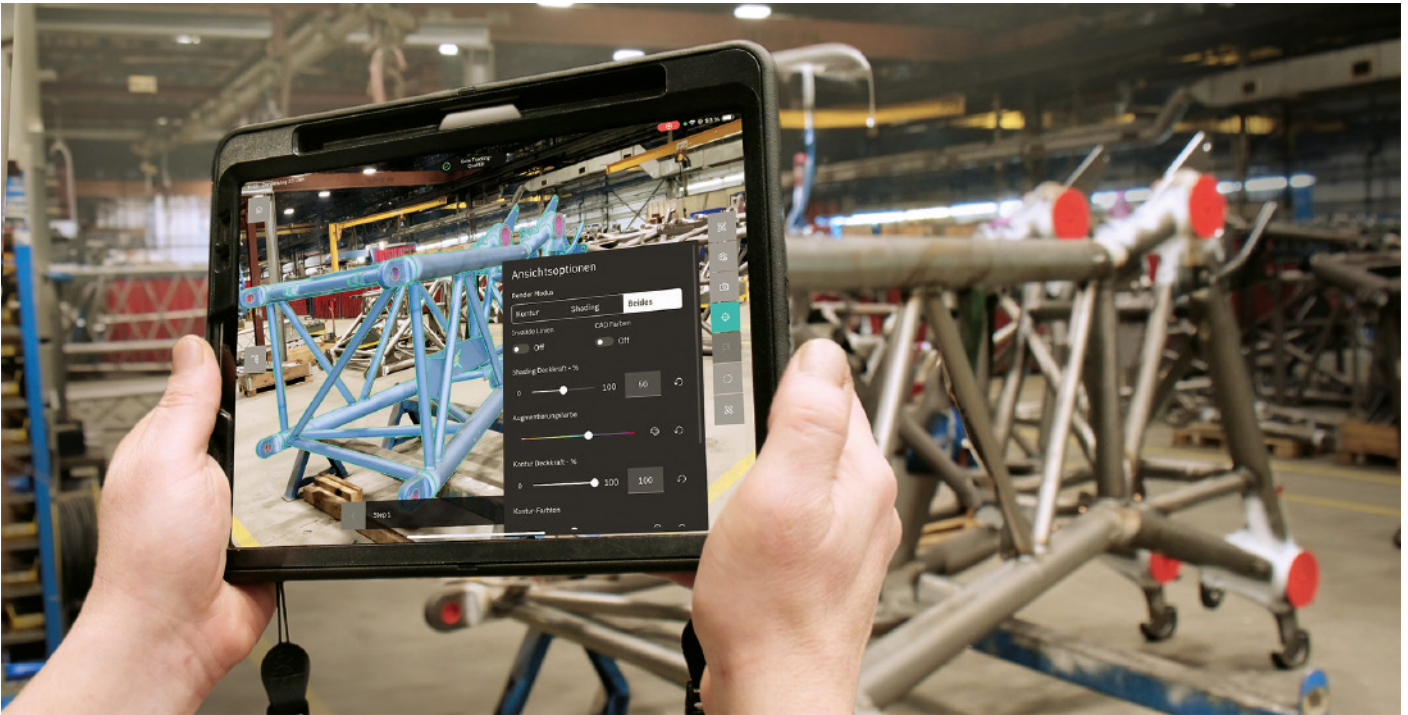
Qualitätskontrolle eines Kran-Kopfstücks in der Produktionshalle von Gothaer Fahrzeugtechnik mit Twyn
