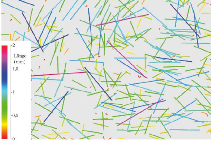
Bild 1: Fasern von veraschtem kohlenstofffaserverstärktem Kunststoff
