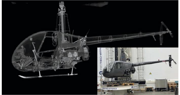
**Schnittbild durch ein 3D-Rendering eines Helikopters:** Trotz der im Inneren verbauten, festen und schwer zu durchdringenden Werkstoffe ist die Abbildung nahezu frei von Artefakten, die bei der konventionellen CT weiterer Erläuterungen bedürften. Unten rechts ist der Messaufbau des Helikopters auf dem Drehteller der XXL-CT Anlage zu sehen.
