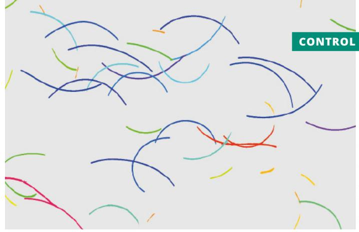
Bild 2: Mit der CLT bearbeitete Durchlichtaufnahme von Buchenholzfasern
